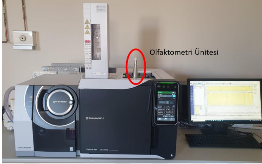
Şekil 3.8. Aroma-aktif bileşiklerin belirlendiği GC-MS-Olfaktometri cihazı
