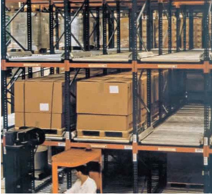
Resim 2.7. Kayar raf sistemi [19]
