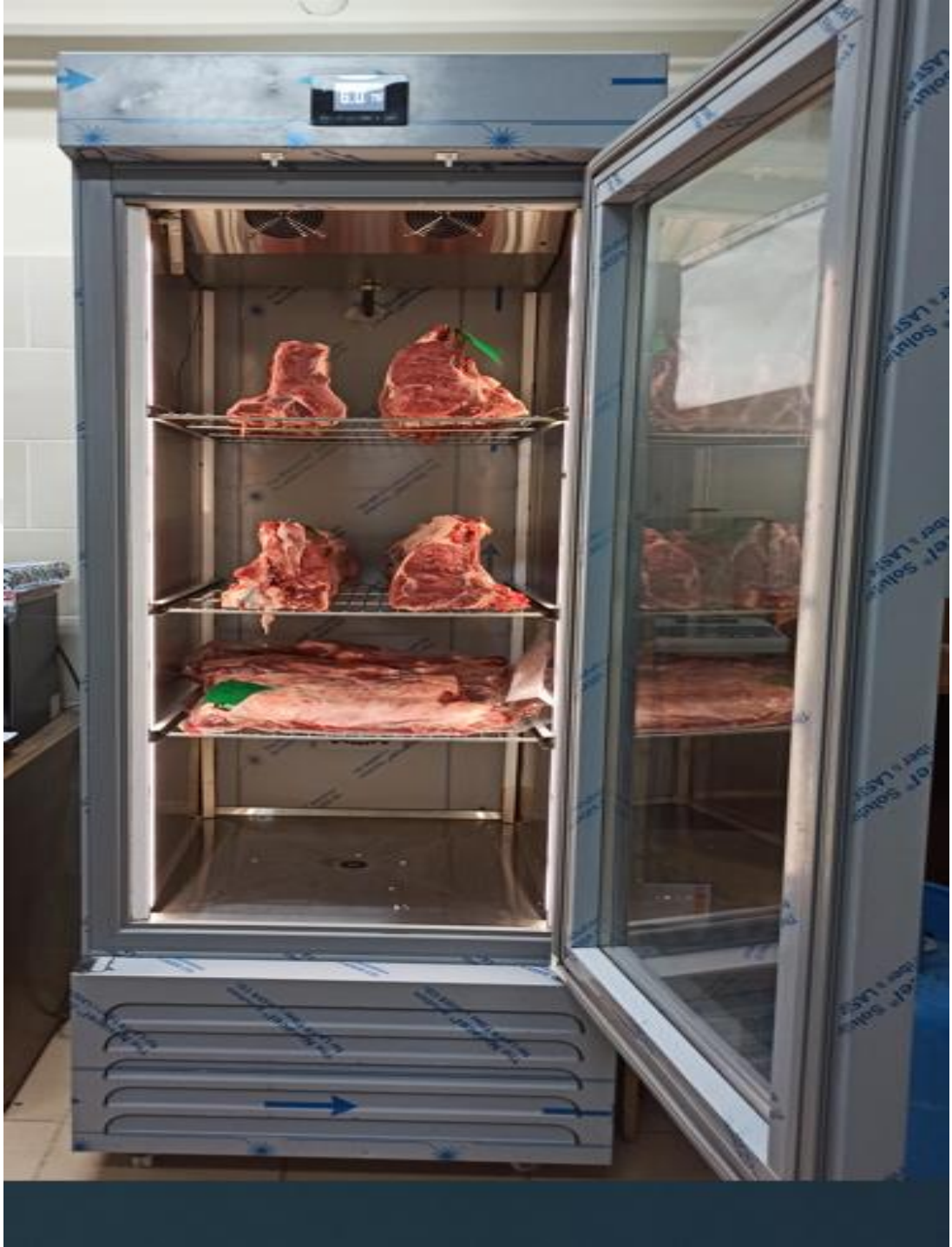
Resim 3.1: Numunelerin olgunlaştırma işleminin gerçekleştirildiği et olgunlaştırma dolabı.
