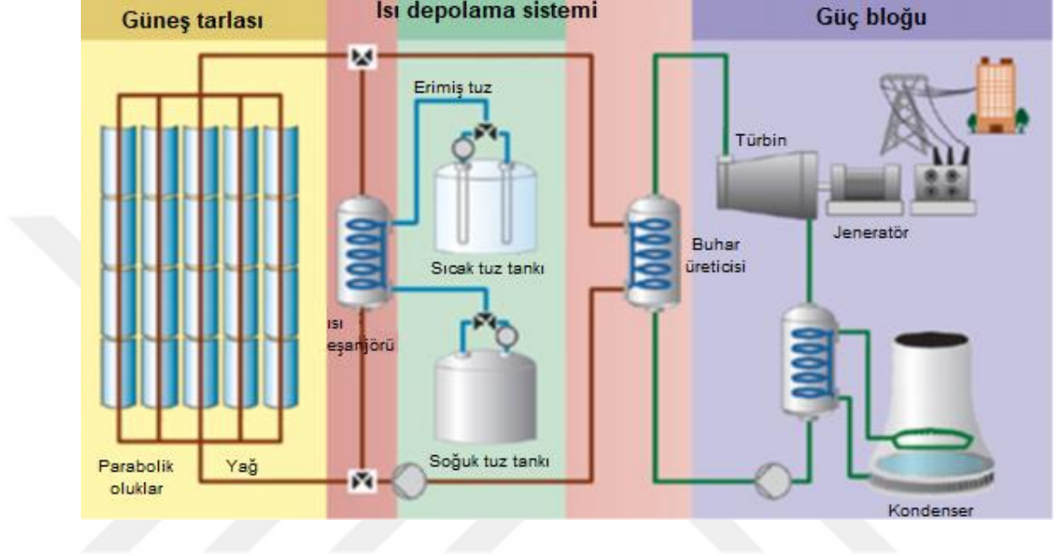
Şekil 4.1. Önerilen PTCSP santralinin şematığı (Bilal Awan vd., 2020)
