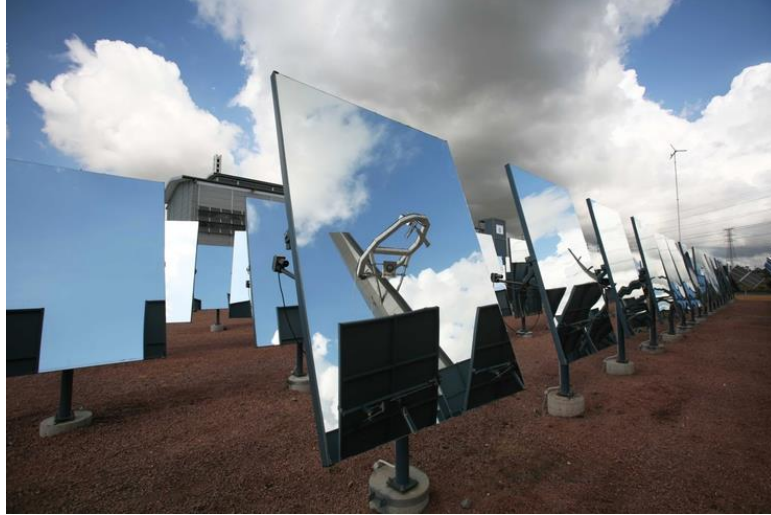
Şekil 3.12. Heliostat ayna modeli (SIC, 2019).
