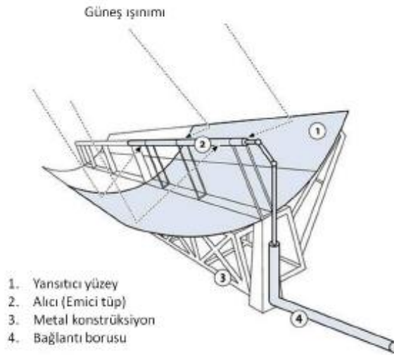
Şekil 3.9. Parabolik oluk kolektör düzeneği (Acar, 2014).
