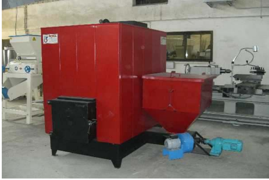
Şekil 4.2. Tarım ürünlerini kurutmak için kullanılan endüstriyel gıda kurutma makinesi
