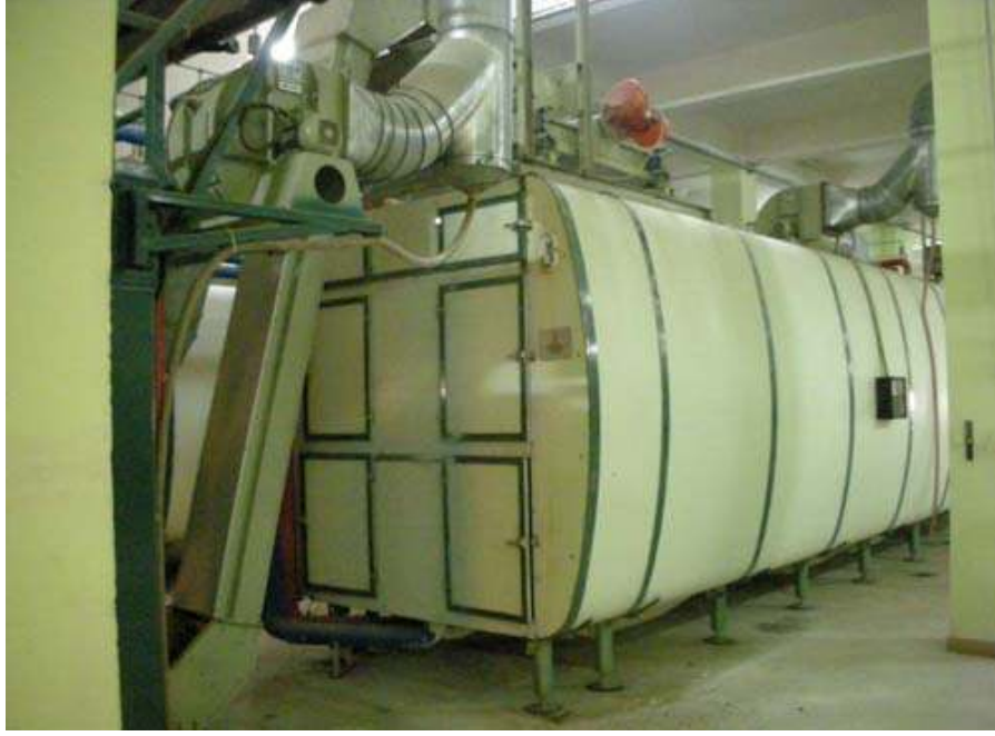
Şekil 4.1. Makarna kurutmada kullanılan endüstriyel gıda kurutucusu
