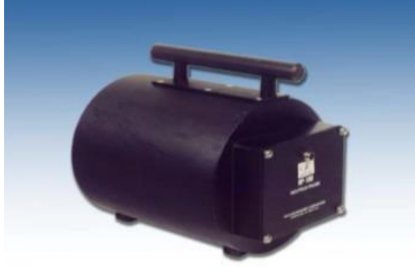
Şekil 3. 1. Deneyde kullanılan ADM-606 Model NP serisi nötron dedektörü ve nötron kaynağı.
