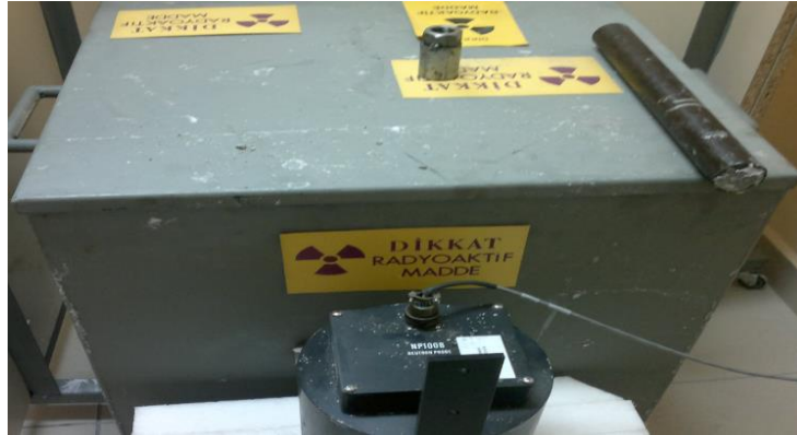
Şekil 3. 10. Deneyde kullanılan nötron kaynağı
