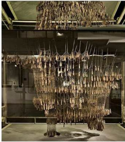
Şekil 2.3. Gaudi'nin Colonia Guell Kilisesi'ni tasarlamak için kullandığı analog parametrik mekanizma (sol) ve kilisenin nihai tasarımını gösteren bir model (sağ) (Assasi, 2019)
