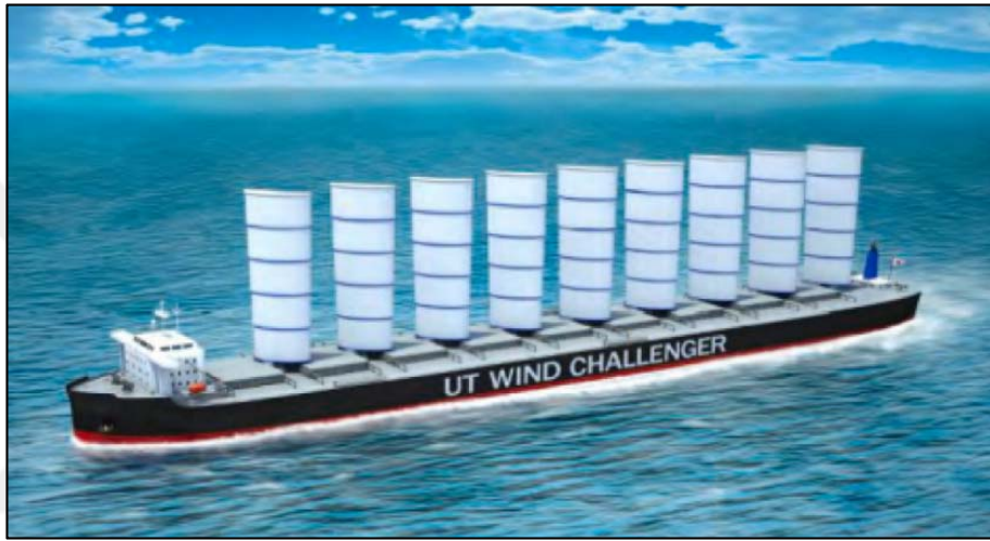
Şekil 4.1 UT Wind Challenger gemisi (Ouchi vd., 2013)
