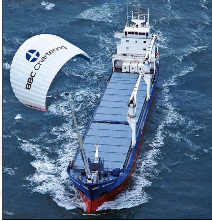
Şekil 4.8 Skysails paraşüt sistemi ile donatılmış Bbc Skysails adlı gemi (SkySails, 2021)
