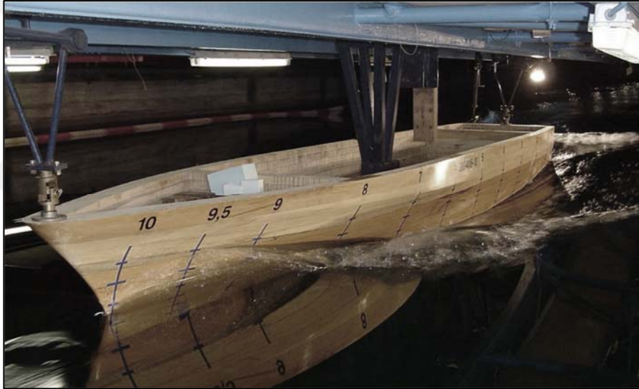
Şekil 3.2 Bir gemi modeline ait direnç deneyi (VardMarine, 2021)
