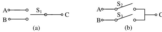
Şekil 2.3. a) Üç uçlu ve üç durumlu anahtar, b) İki uçlu anahtarlarla simüle edilmiş uygun anahtarlama fonksiyonlu eşdeğer devresi
