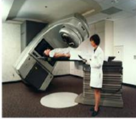
Şekil 5.1. Modern bir 3 GHz doğrusal hızlandırıcı hasta çevresinde dönerek elektron ve foton tedavileri için kullanılır. Öyle ki hüzmeye herhangi yönden hedefe yönelebilir (Amaldi, 2001).
