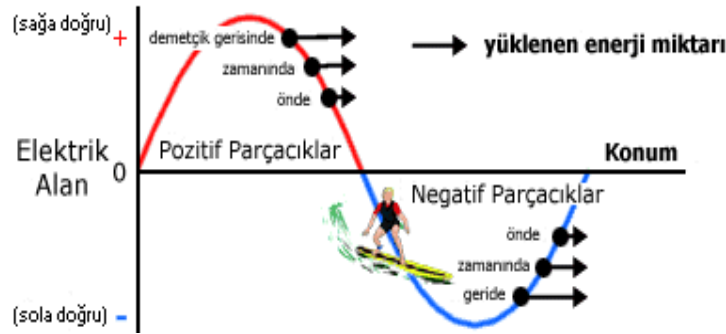
Şekil 2.1. Hareket halindeki EM dalganın yolu üzerindeki parçacıkların sürüklenmesi (Bilim ve Teknik Dergisi, 2004).
