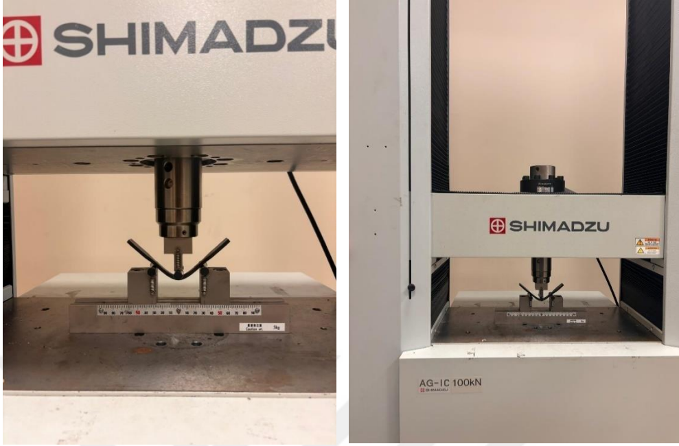
Resim 6.2 Üç nokta eğilme deneyi
