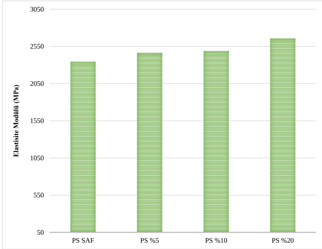
Ek Şekil 9. Dolgu miktarı değişimine bağlı olarak gama ışımasına tabi tutulmuş PS'nin elastisite modülü değerleri
