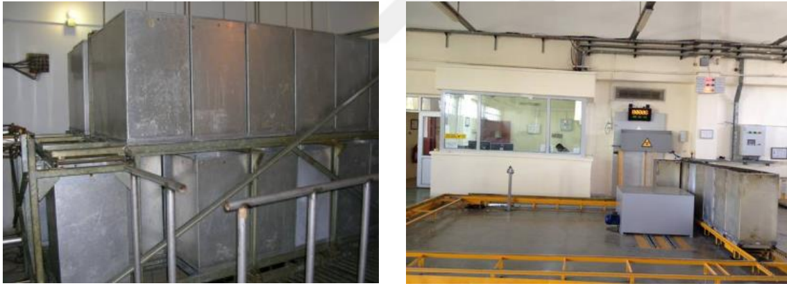
Resim 4.2 Gama ışınlama odası ve oda içindeki ışınlama kutuları (URL-18, 2022)
