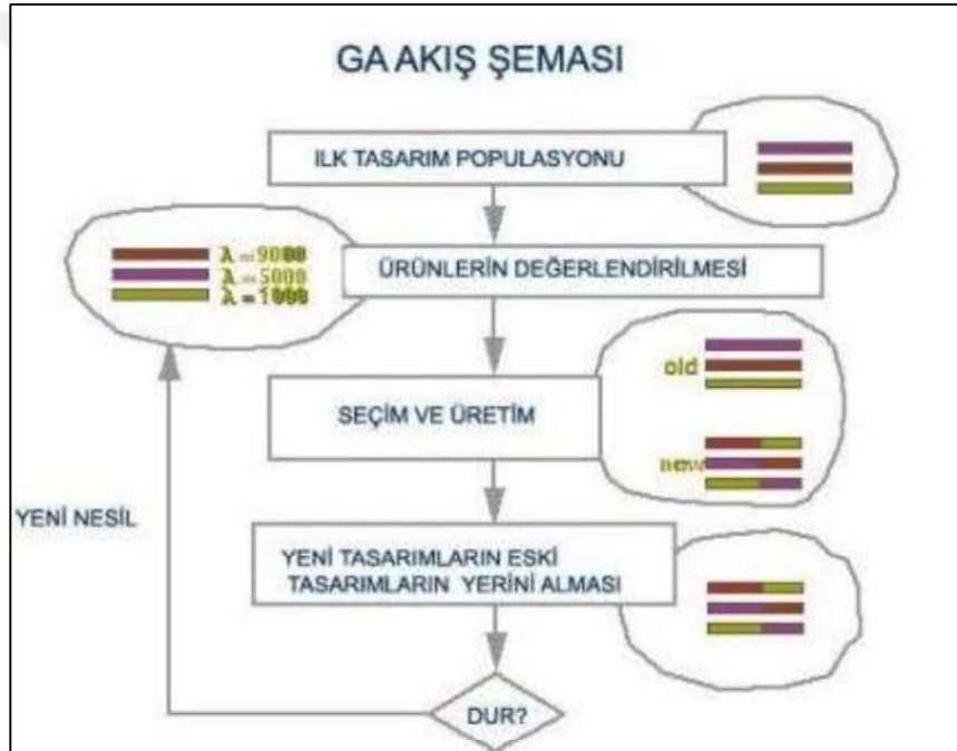
Şekil 8: Genetik algoritmanın işlem basamakları
