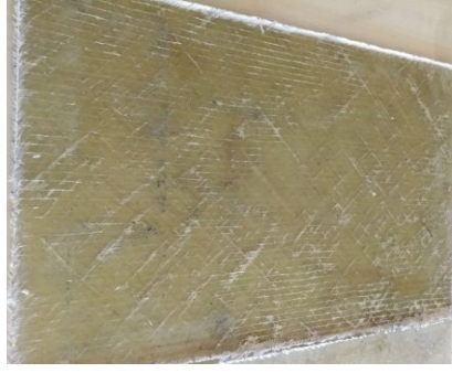
Şekil 2.10. Cam elyaf takviyeli polyester matrisli kompozit plaka.
