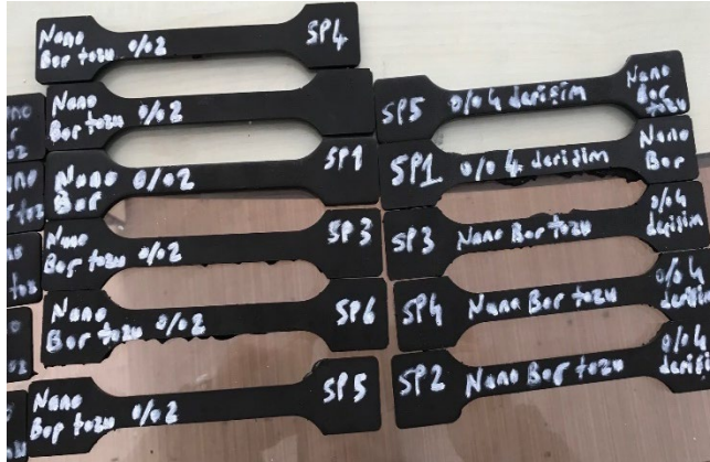
Şekil 2.8. Hazırlanan katkılı ve katkısız test numuneleri.
