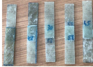
Şekil 2.13. Çalışma sırasında yapılan tek bindirmeli bağlantı numuneleri.
