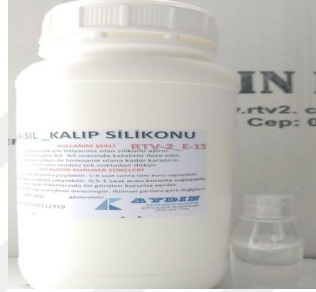
Şekil 2.1. Numune kalıp imalatında kullanılan kalıp silikonu ve katalizörü.
