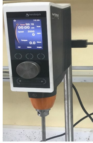
Şekil 2.7. Mekanik karıştırma cihazı.
