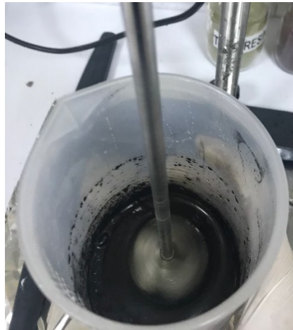
Şekil 2.6. Mekanik karıştırma işlemi.
