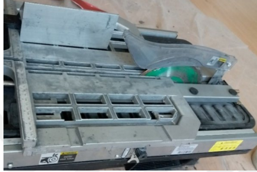
Şekil 2.11. Kompozit plakaların kesimi için kullanılan testere cihazı.
