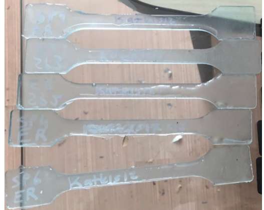
Şekil 2.8. Hazırlanan katkılı ve katkısız test numuneleri.
