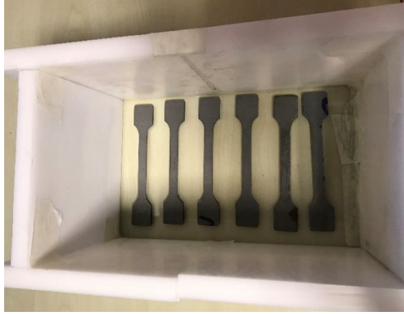
Şekil 2.3. Silikon kalıbın hazırlanması.
