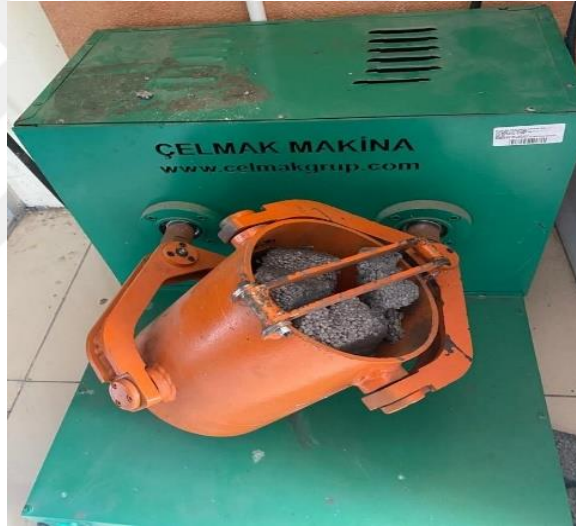
Şekil 3.2 Turbula tipi toz karıştırma makinesi
