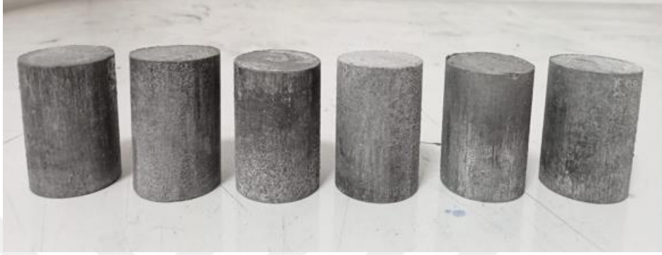
Şekil 3.4 Sıkıştırma sonrası üretilen numuneler (Al (%95) – SiC (%5) – Üre)
