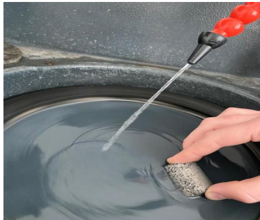
Şekil 3.6 Alüminyum köpüklerin zımparalama işlemi
