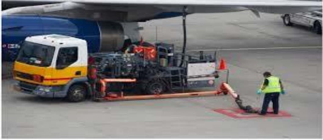
Şekil 2.5. Yakıt ikmalinde yapılan topraklama örneği [20].
