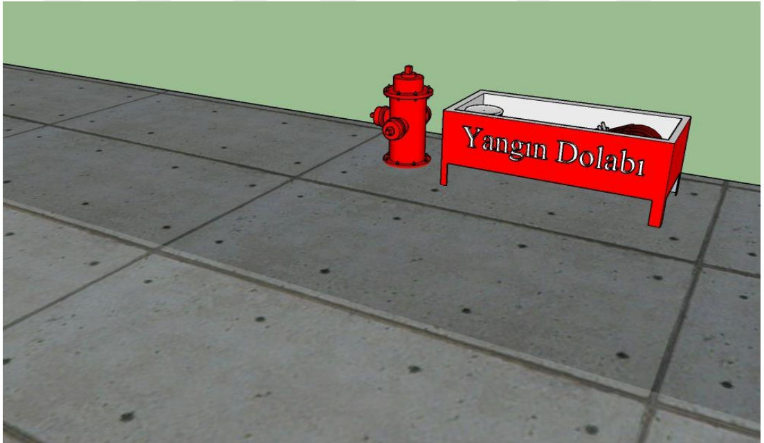
Şekil 4.10. Uçak park yeri yangın dolabı dar açılı görünüm [67].
