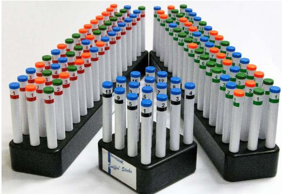
Resim 2. Koku çubukları test bataryasında bulunan koku eşik testi (solda), koku tanımlama testi (ortada) ve koku ayırt etme testi (sağda) çubukları.
