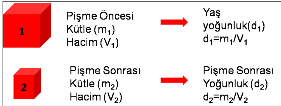
Şekil 3.8. Numunelerin boyutsal değişimlerine göre yoğunluk değerlerinin saptanması
