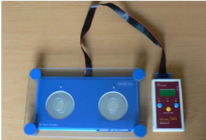
Şekil 1.3 Manyetik sensörlü dijital parmak vuru testi cihazı.
