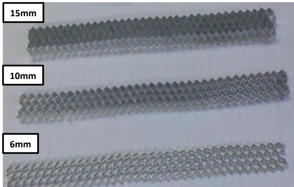
Şekil 3.4. Deney numunelerinde kullanılan farklı yüksekliklerdeki alüminyum bal petekleri
