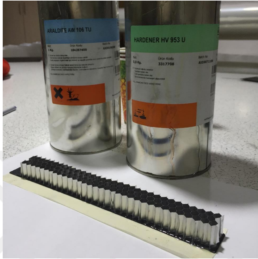
Şekil 3.5. Araldite AW 106 TU ve HV 953 U marka yapıştırma elemanları
