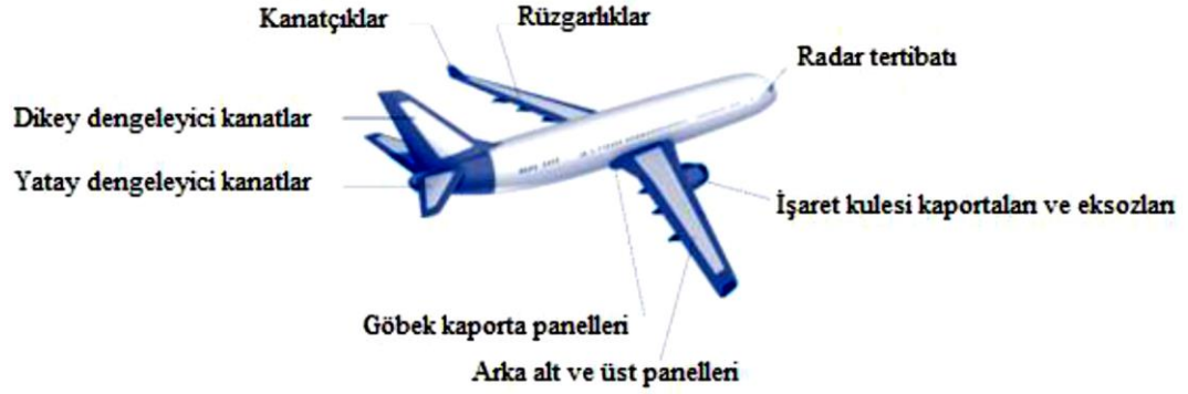
Şekil 2.15. Yolcu uçağının dış yapısında kullanılan kompozit yapıların kullanım bölgeleri (Hexcel 2013)
