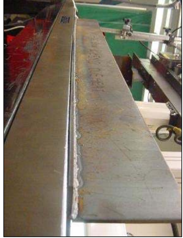
Şekil 5.27: Deney 3’te karşılaşılan eğilme ve Deney 6’da karşılaşılan eğilme
