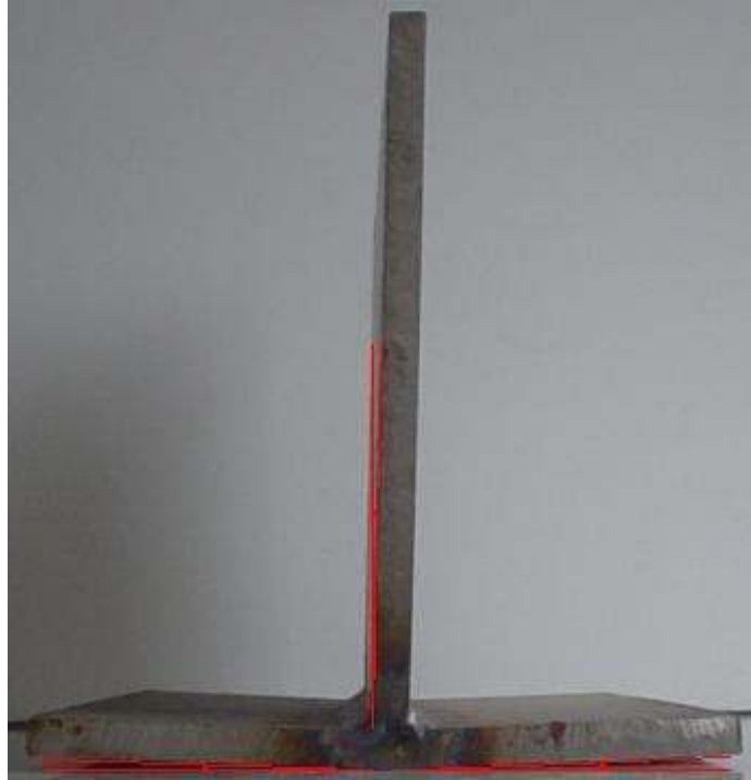
Şekil 6.20: İç köşe kaynağı, çift taraftan sürekli kaynak
