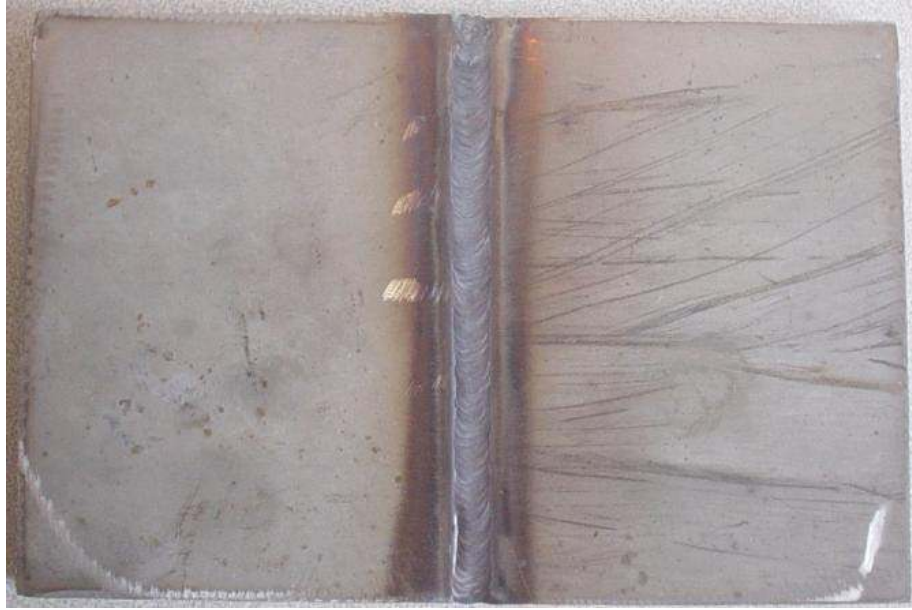
Şekil 6.11: (Y) Kaynak ağızı 60^\circ açı ile hazırlanmış parçanın kaynağı
