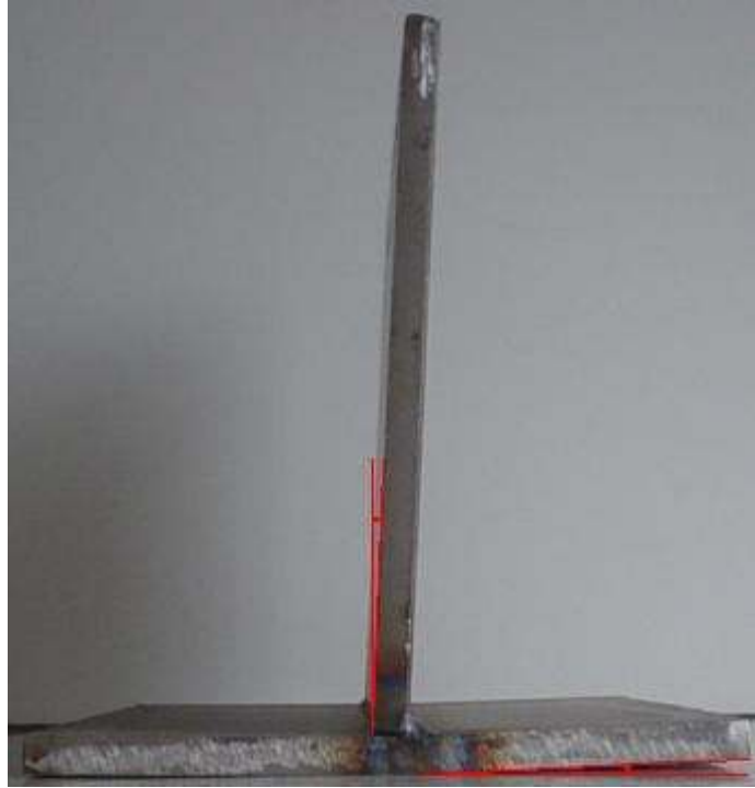
Şekil 6.18: İç köşe kaynağı, tek taraftan sürekli kaynak
