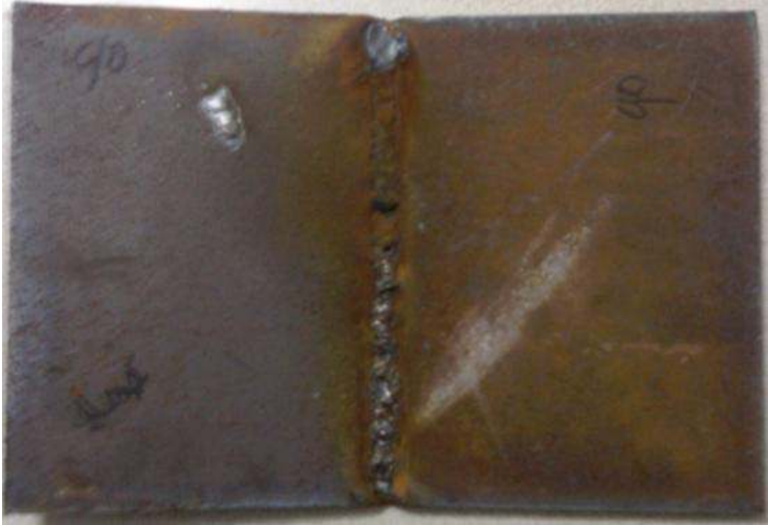
Şekil 6.26: 90° - (V) Kaynak ağızı ile kaynak edilmiş parça
