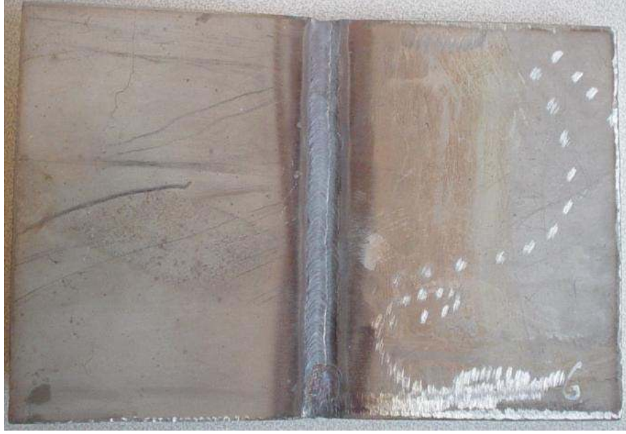
Şekil 6.13: (V) Kaynak ağızı 50^\circ açılı ile hazırlanmış parçanın kaynağı
