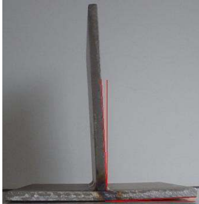
Şekil 6.22: İç köşe kaynağı, çift taraftan kesikli kaynak
