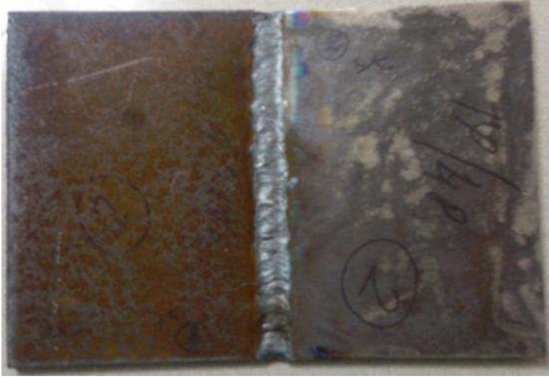
Şekil 6.24: 70° - (V) Kaynak ağızı ile kaynak edilmiş parça
