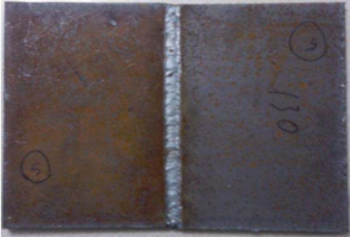
Şekil 6.31: (Y) Kaynak ağızı 60^\circ açılı ile hazırlanmış parçanın kaynağı
