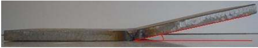
Şekil 6.4: 70° - (V) Kaynak ağızı ile kaynak edilmiş parça
