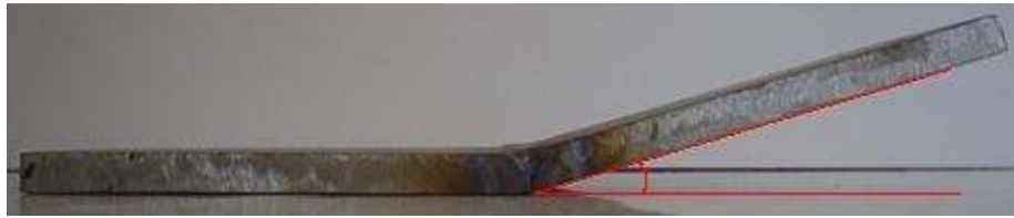
Şekil 6.6: 90° - (V) Kaynak ağızı ile kaynak edilmiş parça
