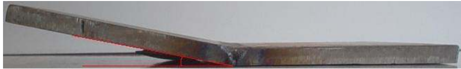
Şekil 6.14: (V) Kaynak ağızı 50^\circ açılı ile hazırlanmış parçanın kaynağı
