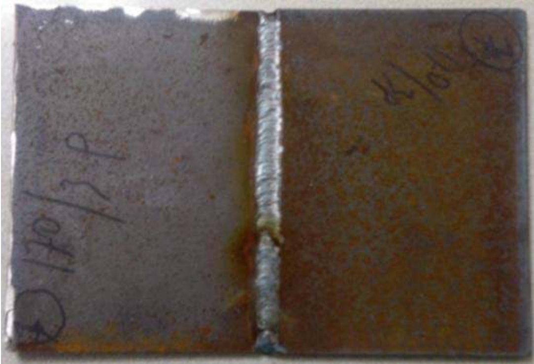
Şekil 6.34: (V) Kaynak ağızı 60^\circ açılı ile hazırlanmış parçanın kaynağı
