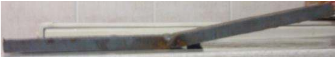
Şekil 6.27: 90° - (V) Kaynak ağızı ile kaynak edilmiş parça
