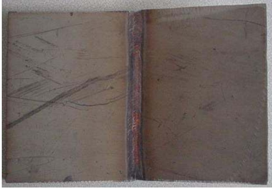
Şekil 6.5: 90° - (V) Kaynak ağızı ile kaynak edilmiş parça
