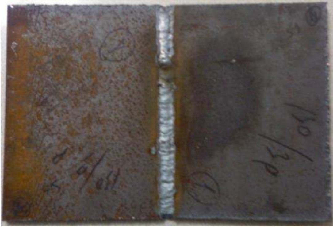
Şekil 6.23: 45° - (V) Kaynak ağızı ile kaynak edilmiş parça
