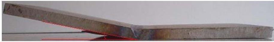
Şekil 6.16: (V) Kaynak ağızı 60^\circ açılı ile hazırlanmış parçanın kaynağı
