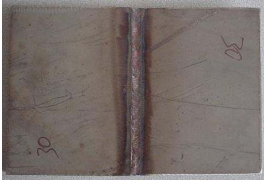
Şekil 6.1: 45° - (V) Kaynak ağızı ile kaynak edilmiş parça
