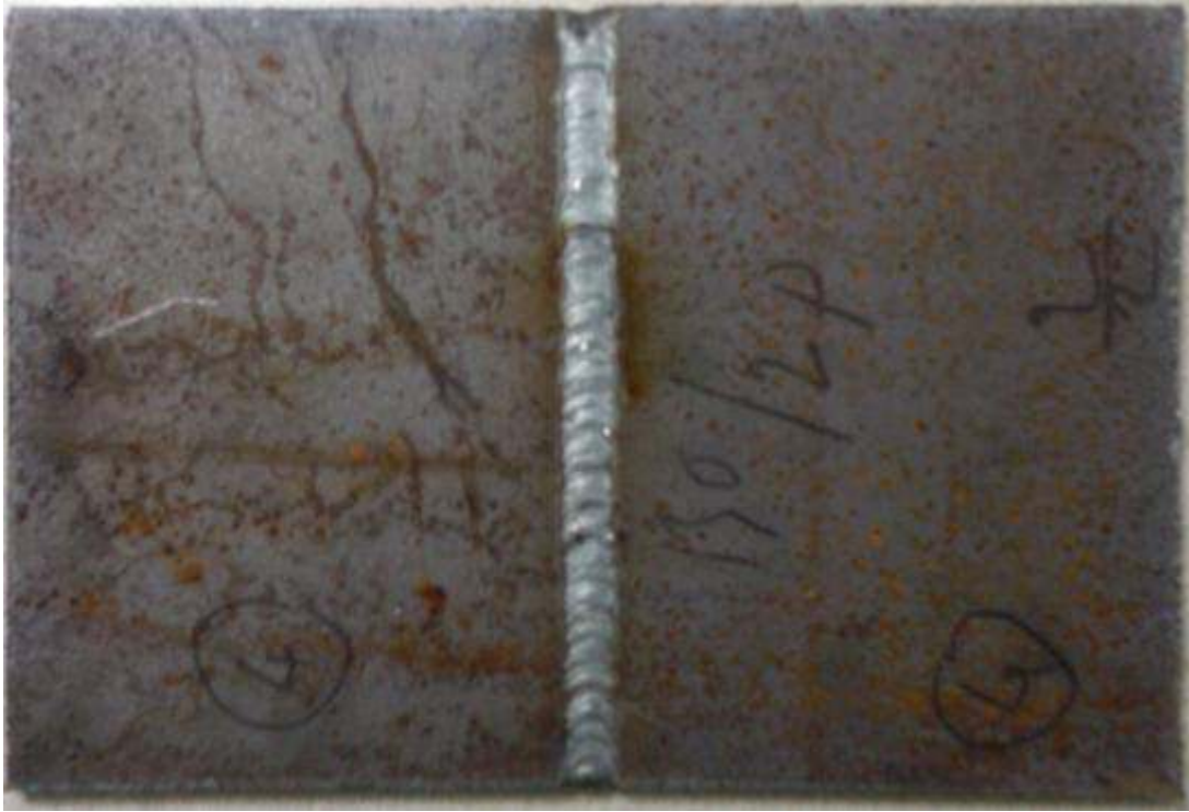
Şekil 6.29: (X) Kaynak ağzı 90° ile kaynak edilmiş parça
