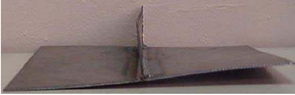
Şekil 5.37: Deney 1’de meydana gelen bükülme
