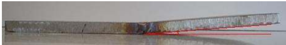
Şekil 6.2: 45° - (V) Kaynak ağızı ile kaynak edilmiş parça
