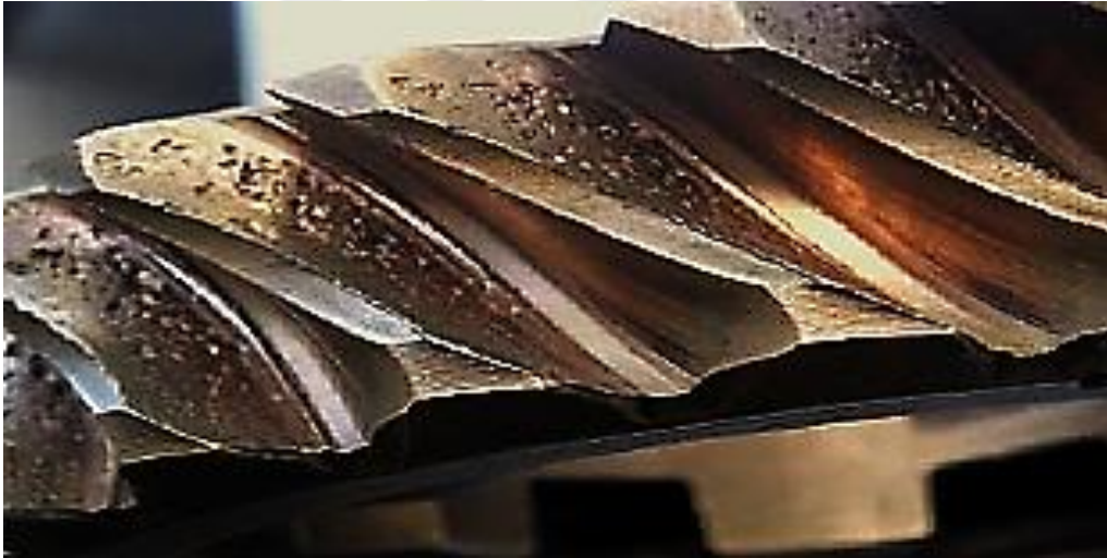
Şekil 4.9: Dişli parçalarda meydana gelen yorulma aşınması (Teber, 2015).
