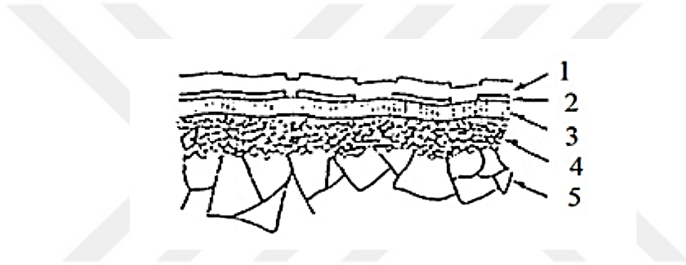
Şekil 3.4: Kuru sürtünme esnasında yüzey durumu, (1) Oluşan pislik tabakası (2) Absorbsiyon tabakası (3) Meydana gelen oksit içerikli tabaka (4) Soğuk şekillenmiş tabaka (5) Altlık metal tabaka (Bayer, 1994).
