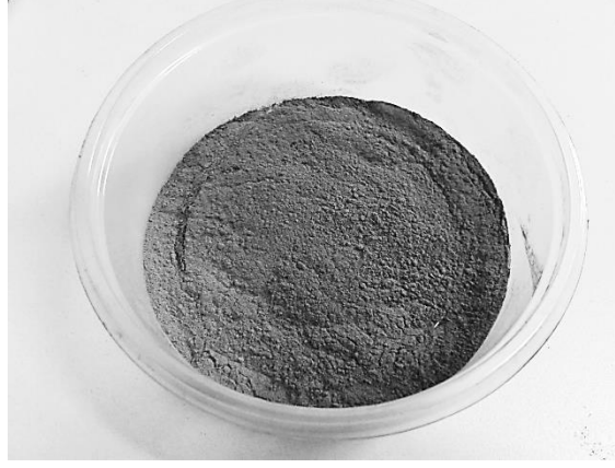
Şekil 6.1: Mo kaplama tozu.
