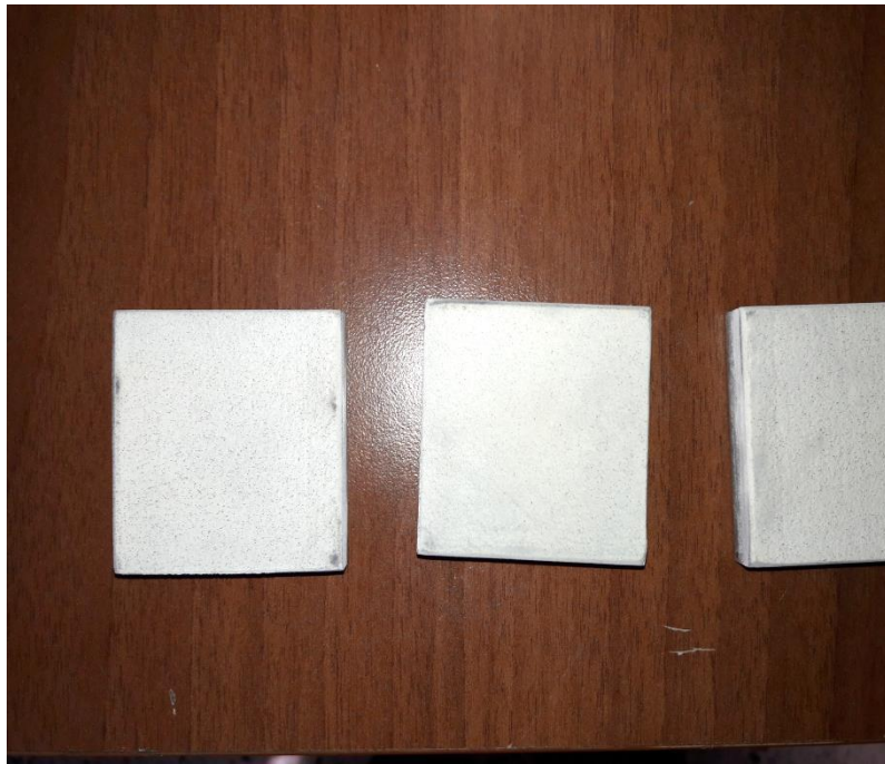
Şekil 6.5: 100 Mikron NiCrAlY kaplama tozu üzerine yapılmış olan 200 mikronluk ZrO 2 kaplama.
