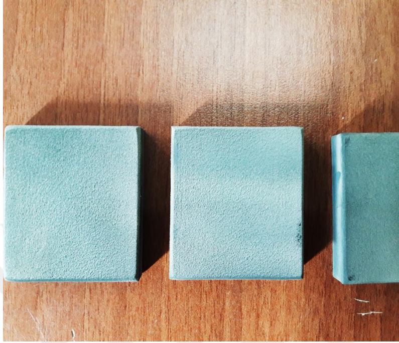
Şekil 6.4: 300 mikron NiCrAlY kaplama tozu ile kaplanmış numune.
