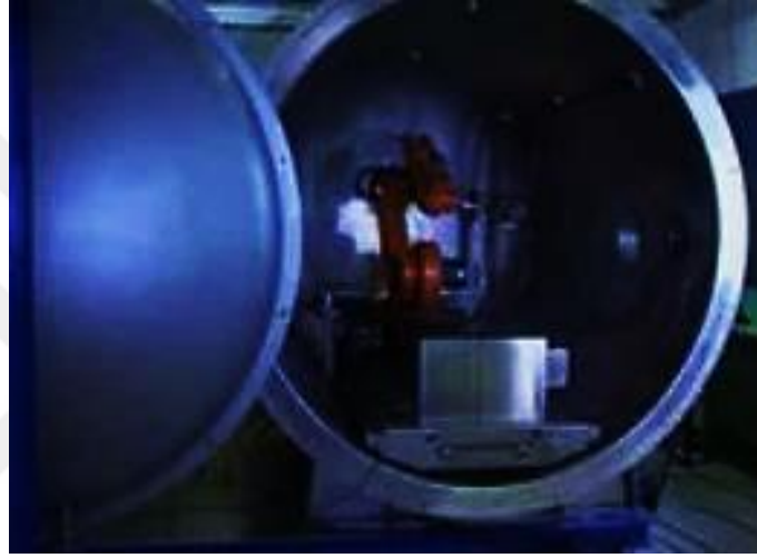
Şekil 5.5 Vakum plazma sistemi gösterimi (Davis, 2004).
