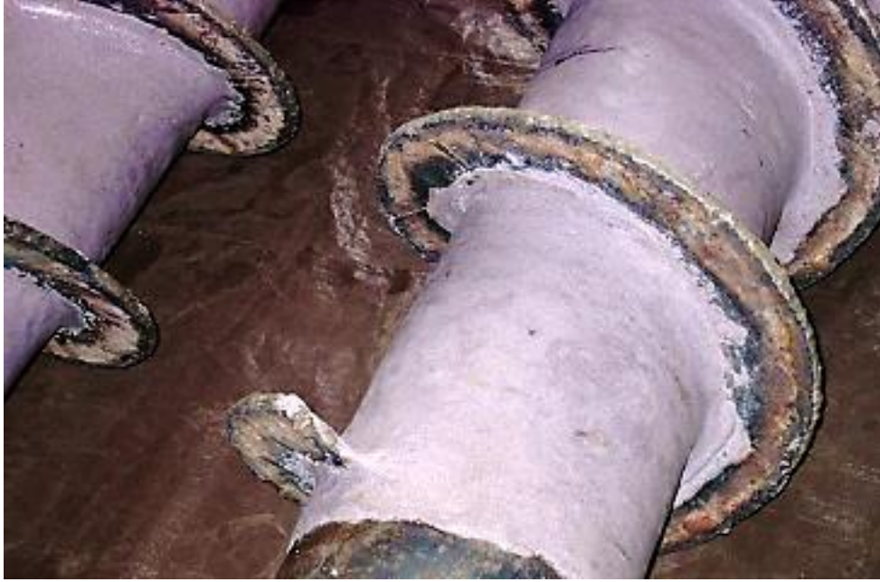
Şekil 4.4: Madenlerde kullanılmakta olan toprak kazıyıcı makine elemanlarında meydana gelen abrazif aşınma (Stachowiak vd., 2005).
