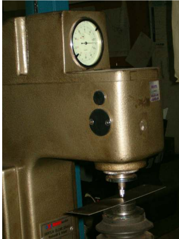
Şekil 8.2 Deney parçalarının sertliklerinin ölçümü.
