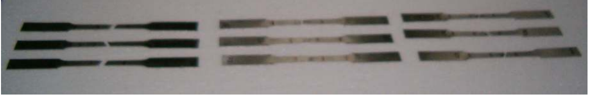
Şekil 8.35 Deneylerde kullanılan kopmuş çekme numuneleri
