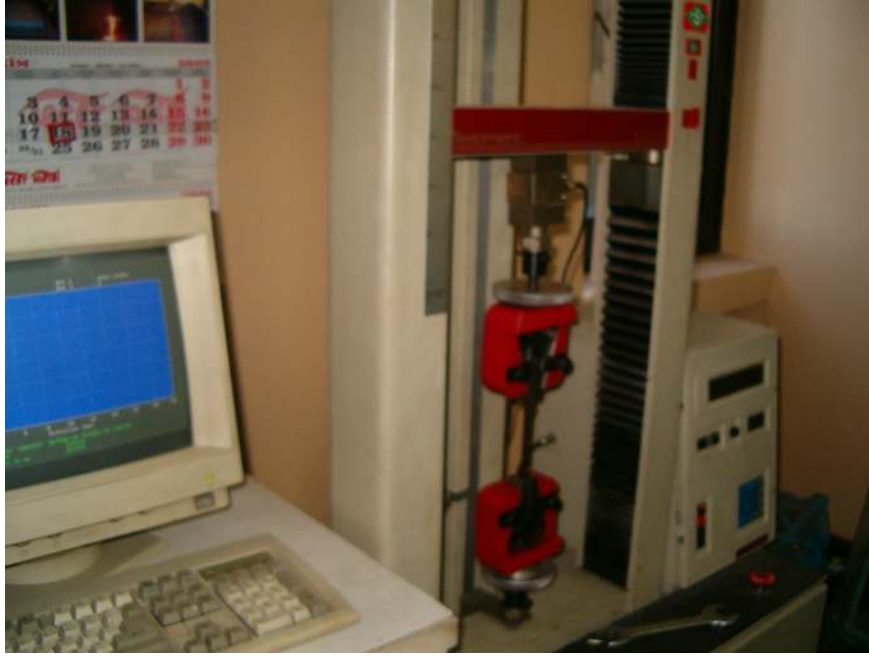
Şekil 8.18 Çekme deneylerinde kullanılan TESTOMETRIC- 3 tonluk deney makinası
