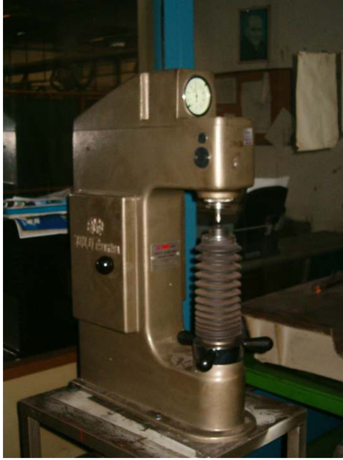
Şekil 8.1 Rockwell sertlik ölçme cihazı.
