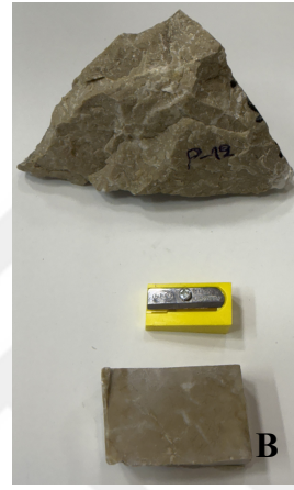
Şekil 3.44. P-12 Tepecik anakaya Losyonun (A) Ana yapıdan kullanılan kayaç, (B) kesme makinesinde hazırlanmış
