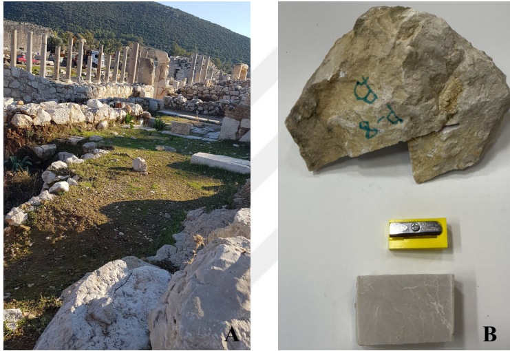
Şekil 3.36. P-8-B Losyonun(A)Ana yapıdan kullanılan kayaç, (B) kesme makinesinde hazırlanmış
