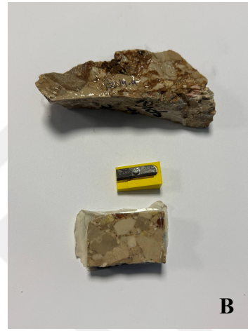
Şekil 3.48. P-14-A(A)Ana yapıdan kullanılan kayaç,(B)kesme makinesinde hazırlanmış
