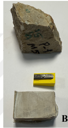
Şekil 3.54. P-15-A losyonun (A)Ana yapıdan kullanılan kayaç, (B) kesme makinesinde hazırlanmış
