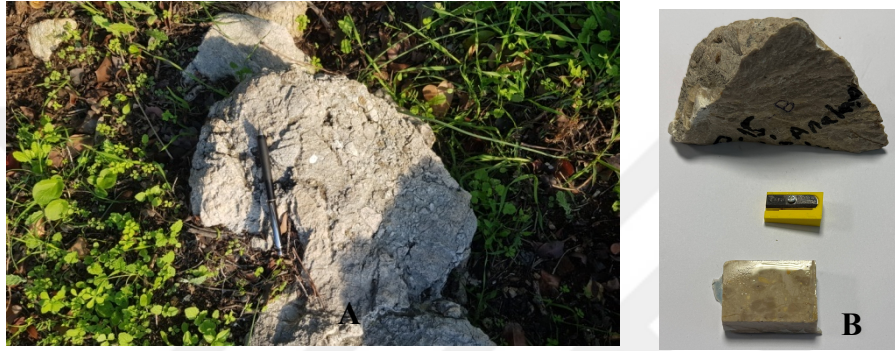
Şekil 3.56. P-15-B (A)Ana yapıdan kullanılan kayaç,(B)kesme makinesinde hazırlanmış
