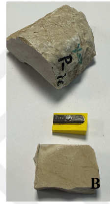
Şekil 3.58. P-16 Losyonun(A) Ana yapıdan kullanılan kayaç, (B) kesme makinesinde hazırlanmış.
