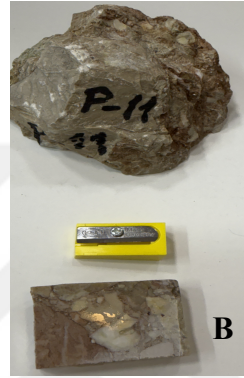
Şekil 3.42. P-11 kent kapısı anakayaç losyonun (A) Ana yapıdan kullanılan kayaç, (B) kesme makinesinde hazırlanmış
