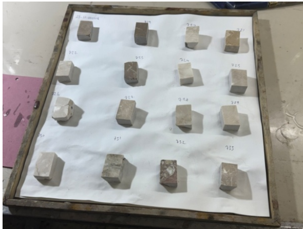
Şekil 3.5. Küçük kareler şeklinde taş kesme makinesinde hazırlanmış örnekler
