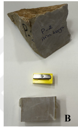
Şekil 3.16. P-2 (A) Ana yapıdan kullanılan kayaç, (B) kesme makinesinde hazırlanmış
