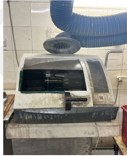
Şekil 3.4. (A) Araziden alınan el örnekler. (B) Taş kesme makinesi
