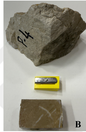
Şekil 3.24. P-4(Yapı) Losyonun (A) Ana yapıdan kullanılan kayaç, (B) kesme makinesinde hazırlanmış
