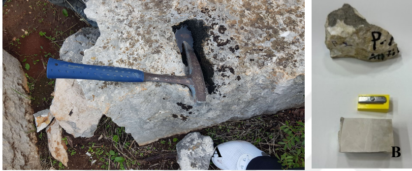
Şekil 3.22. P-3(antik) (A) ana yapıdan kullanılan kayaç, (B) kesme makinesinde hazırlanmış
