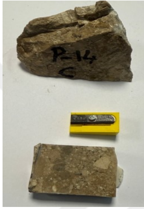
Şekil 3.52. P-14-C Losyonun kesme makinesinde hazırlanmış
