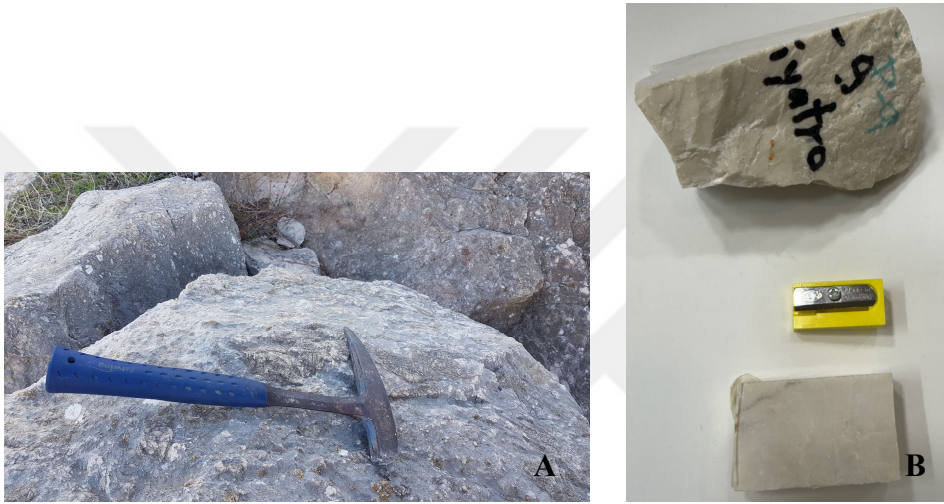
Şekil 3.38. P-9 Tiyatro losyonun(A)Ana yapıdan kullanılan kayaç, (B)kesme makinesinde hazırlanmış
