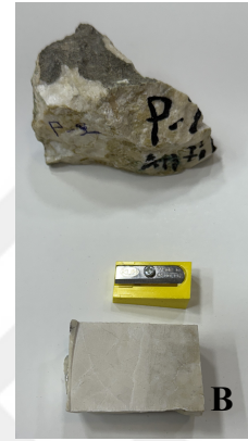
Şekil 3.18. P-2(antik) Losyonun (A) Ana yapıdan kullanılan kayaç, (B) kesme makinesinde hazırlanmış örnek
