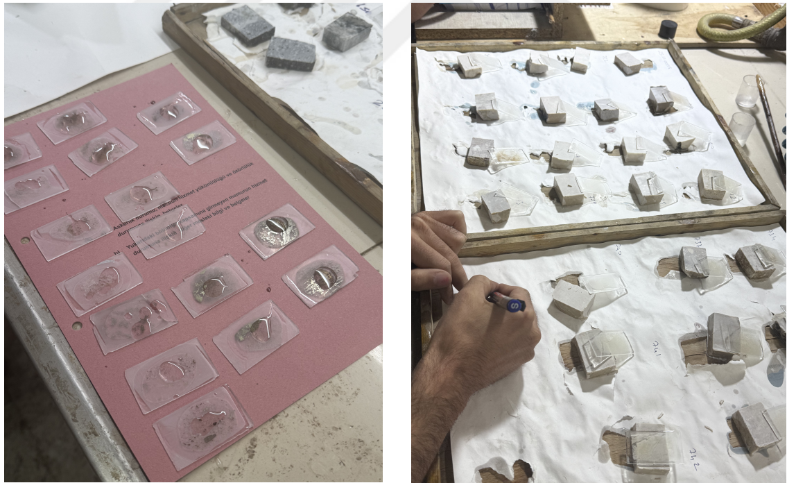
Şekil 3.11. Lamel ile kapatılan numunelerin son aşaması
