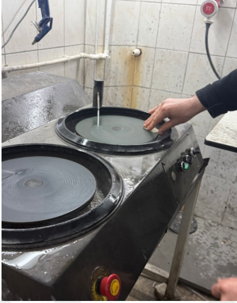
Şekil 3.6. 220'lik aşındırma tozu (kaba), 600'lük aşındırma tozu (ince) ile cam üzerinde bir yüzeyi inceltilir.
