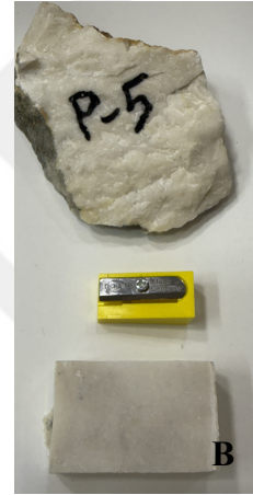
Şekil 3.26. P-5(Yapı) Losyonun(A)Ana yapıdan kullanılan kayaç, (B)kesme makinesinde hazırlanmış
