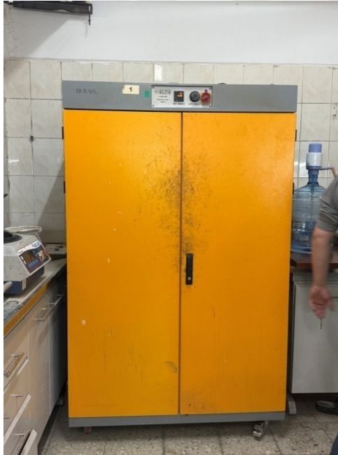
Şekil 3.7. Etüvde numuneleri bekletilerek kurutulmak için kullanılıyor
