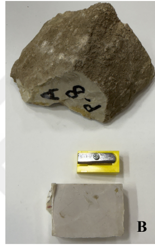
Şekil 3.34. P-8-A (A) Ana yapıdan kullanılan kayaç, (B) kesme makinesinde hazırlanmış
