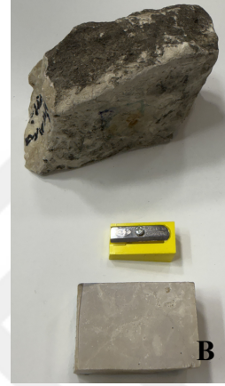
Şekil 3.32. P-7 Nero hamamı zemin Losyonun (A)Ana yapıdan kullanılan kayaç, (B) kesme makinesinde hazırlanmış
