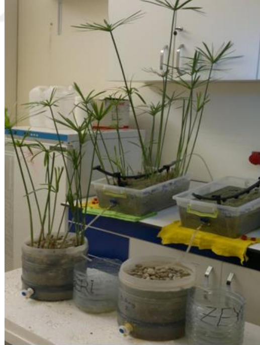
Şekil 3.8. Set-2 deki yapay sulak alan düzeneği
