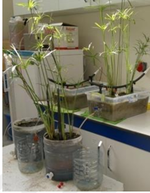
Şekil 3.7. Set-1 deki yapay sulak alan düzeneği
