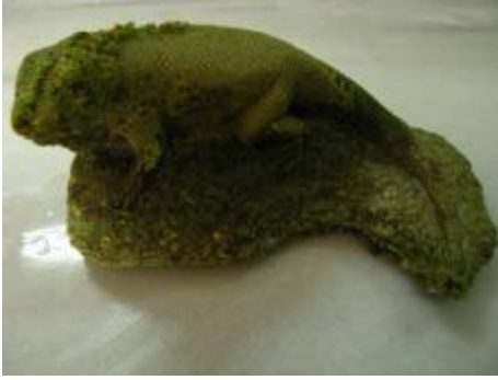
Şekil 208. 875°C sıcaklıkta Pişirilen Soda Şişesi Camı Denemesi
