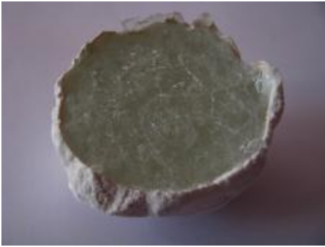
Şekil 143. Kalın Taneli Gazoz Şişesi + %15 Boraks Karışımı Deneme Örneği
