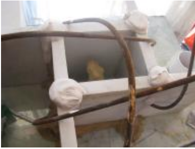
Şekil 150. Hazırlanan modellerin alçı – kuvars karışımından oluşan kalıbı
