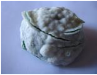
Şekil 128. Kalın Taneli Soda Şişesi + %15 Boraks Karışımı Deneme Örneği.
