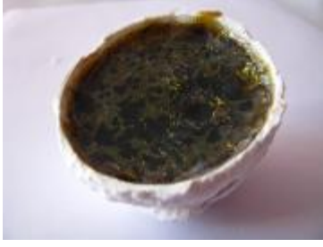
Şekil 135. Kalın Taneli Bira Şişesi + %15 Boraks Karışımlı Deneme Örneği.
