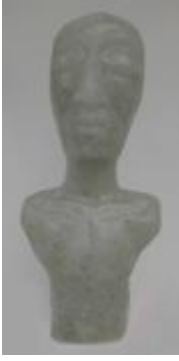
Şekil 229. 920°C’ de Pişirilen Kalın Taneli Gazoz Şişesi Camı, Figür
