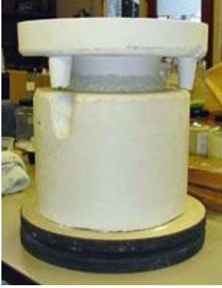
Şekil 58. Fırınlanmak Üzere Üst Kapağı Kapatılan Kalıp.
