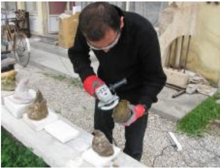
Şekil 234. Taşlama Aleti İle Temizleme İşlemi
