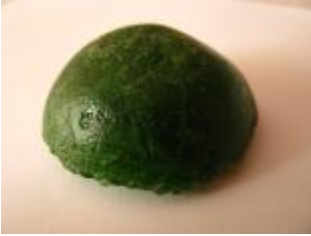
Şekil 124. Kalın Taneli Soda Şişesi Deneme Örneği.
