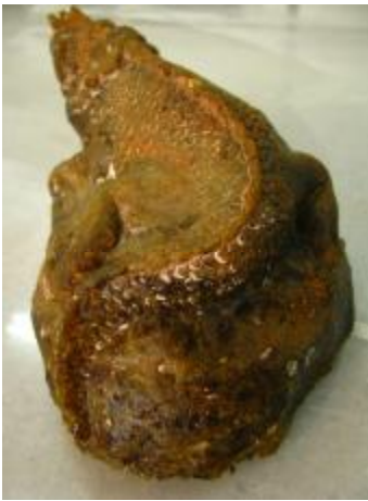
Şekil 206. 920°C Sıcaklıkta Pişirilen Bira Şişesi Camı Denemesi, Arkadan Resmi
