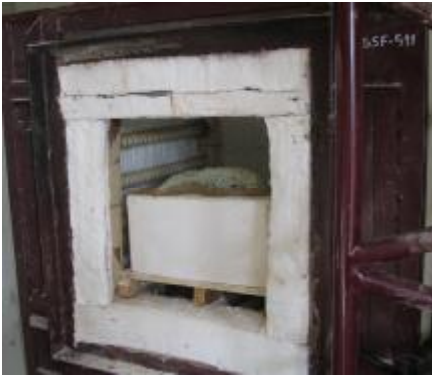
Şekil 200. Seramik Fırınına Yerleştirilmiş Kalıplar
