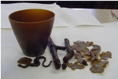
Şekil 45. Balmumundan Oluşturulan Modelin Parçaları. ( http://www.emstudioglass.com/technique.htm adresinden 15 Mayıs 2011 tarihinde edinilmiştir.)
