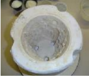
Şekil 53. İçi Boşaltılmış Pate de Verre Kalıbı ( http://www.emstudioglass.com/technique.htm adresinden 15 Mayıs 2011 tarihinde edinilmiştir.)
