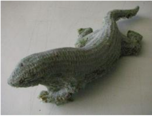
Şekil 211. 875°C Sıcaklıkta Pişirilen Gazoz Şişesi Camı Denemesi
