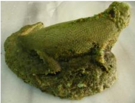
Şekil 209. 875°C sıcaklıkta Pişirilen Soda Şişesi Camı Denemesi, Farklı Açıdan.
