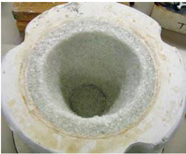
Şekil 57. Kalıbın İçine Şeffaf Cam Takviyesi. ( http://www.emstudioglass.com/technique.htm adresinden 15 Mayıs 2011 tarihinde edinilmiştir.)
