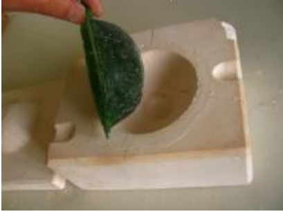
Şekil 179. 900°C’de Pişirimi Yapılan Denemenin Kalıptan Çıktığı Hali
