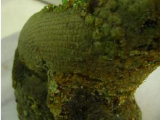
Şekil 210. 875°C sıcaklıkta Pişirilen Soda Şişesi Camı Denemesi, Ayrıntı
