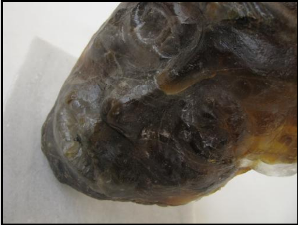
Şekil 258. 920°C’de Fırınlanan Kalın Taneli Bira Şişesi ve Gazoz Şişesi Karışımı, Mask, Ayrıntı
