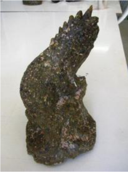
Şekil 214. 920°C Sıcaklıkta Pişirilen Bira Şişesi Camı Denemesi
