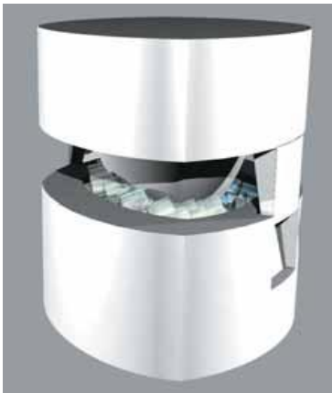
Şekil 27. İçerisine Cam Parçaları Doldurulan Kapaklı Pate De Verre Kalıbı, (Güner, 2009, s98).
