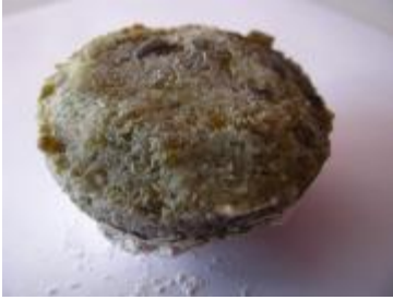
Şekil 133. İnce Taneli Bira Şişesi + %15 Sülyen Karışımı Deneme Örneği
