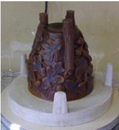
Şekil 48. Üst Kapak Üzerinde Kalıbın Alınacak Model. ( http://www.emstudioglass.com/technique.htm adresinden 15 Mayıs 2011 tarihinde edinilmiştir.)
