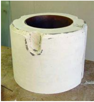
Şekil 51. Hazırlanan Pate de Verre Kalıbı Alt Parçası.
