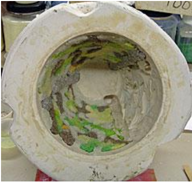
Şekil 56. Renkli Camların Kalıp İçine Dizilimi. ( http://www.emstudioglass.com/technique.htm adresinden 15 Mayıs 2011 tarihinde edinilmiştir.)
