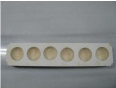
Şekil 113. Denemeler için altılı kalıplar.
