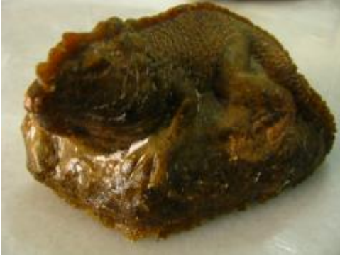
Şekil 204. 920°C Sıcaklıkta Pişirilen Bira Şişesi Camı Denemesi
