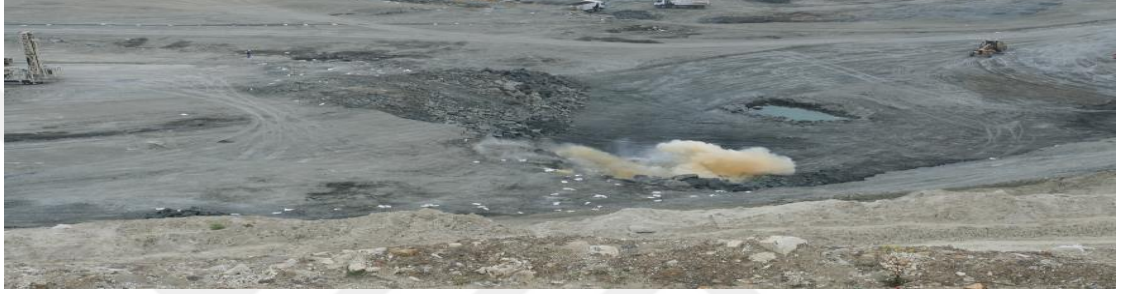
Şekil 5.6 Yetersiz yemleme nedeniyle infilak edemeyen ANFO'nun yanması sonucu turuncu gaz oluşumu
