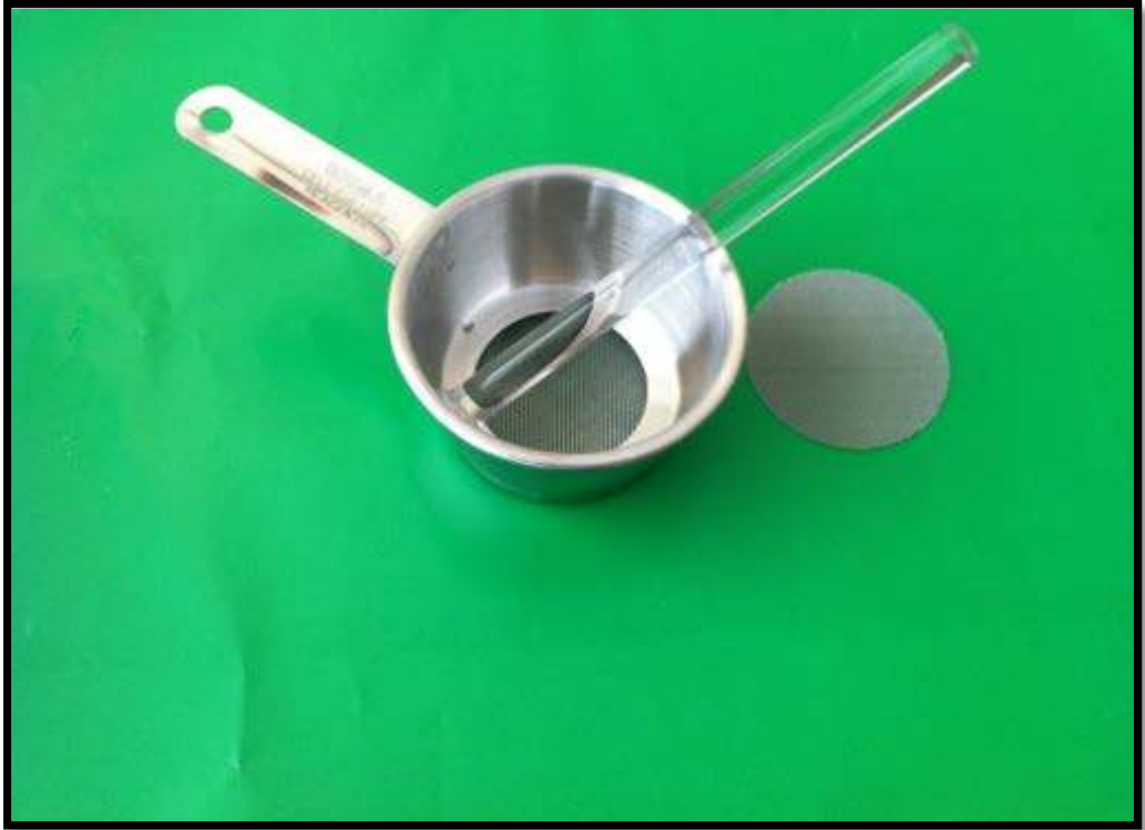
Şekil 3.3. Mikrospor süspansiyonunun süzülmesinde kullanılan elek sistemi
