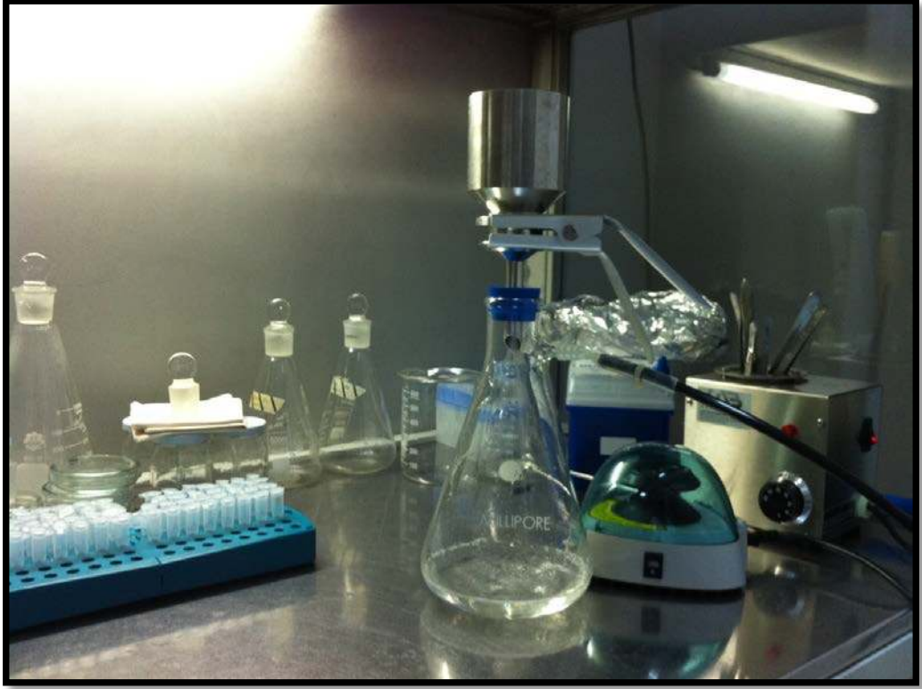
Şekil 3.2. Steril kabin içinde besi ortamının sterilizasyonunun yapılışı
