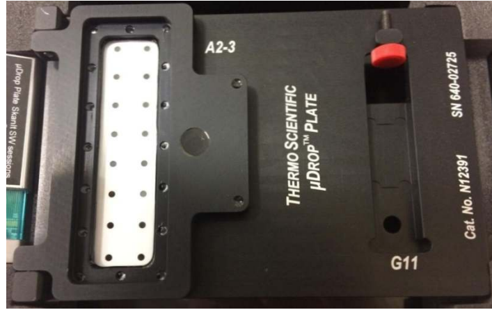
Şekil 3.8. Düşük hacimler örneklerin UV dalga boylarında analizini yapabilen Thermo µDrop plate görüntüsü.
