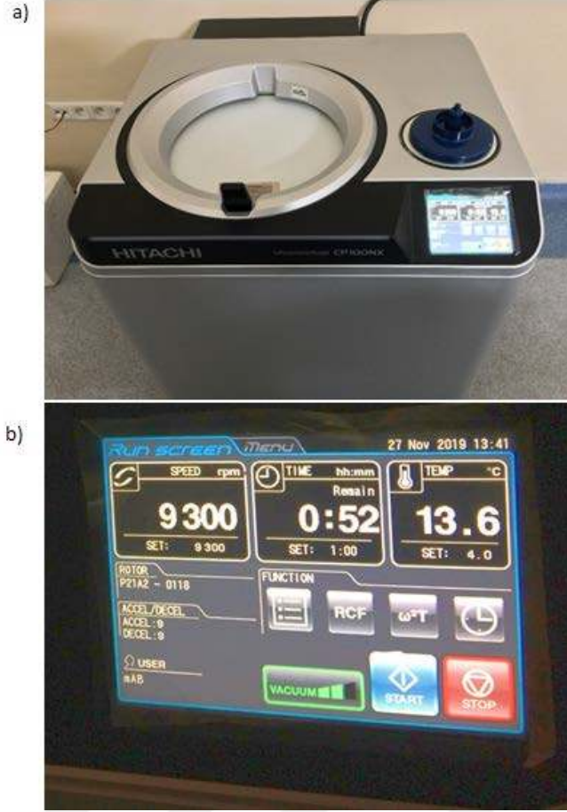
Şekil 3.4. Hitachi CP100NX ultrasantrifüj cihazı (a) ve kontrol menüsü (b).
