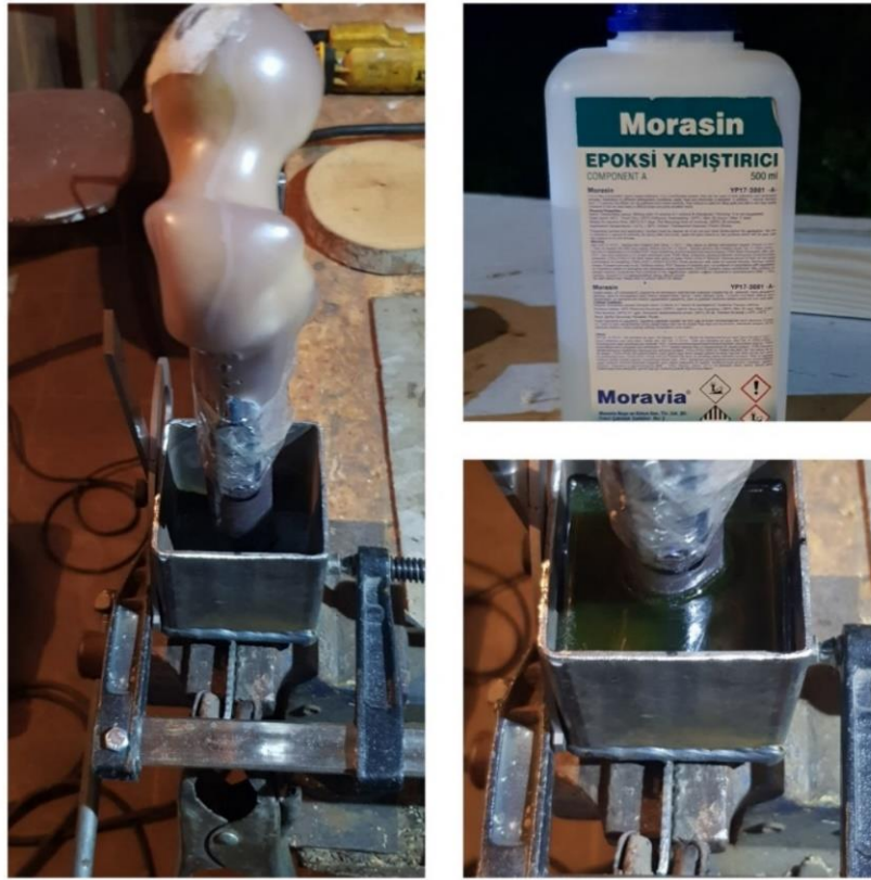
Resim 5: Resmin sol tarafında kalıbın boş hali, sağ tarafta epoksi reçinenin kalıba koyulduktan sonraki fotoğrafı görülmektedir.
