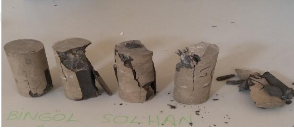
Şekil 3.16 Solhan (Bingöl) silindirik örneklerinin tek eksenli basınç deneyinden sonraki görünüşleri
