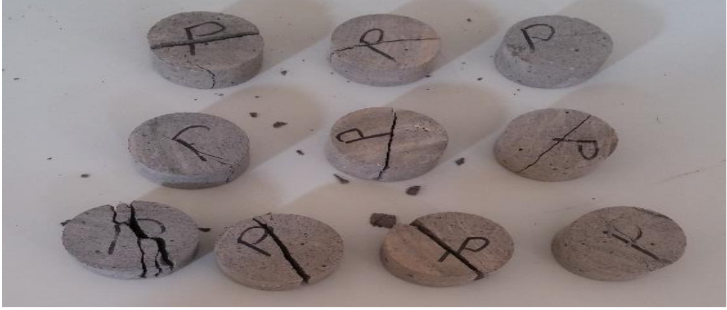
Şekil 3.20. Pazarcık (Kahramanmaraş) örneklerinin brazillian deneyinden sonraki görünüşleri
