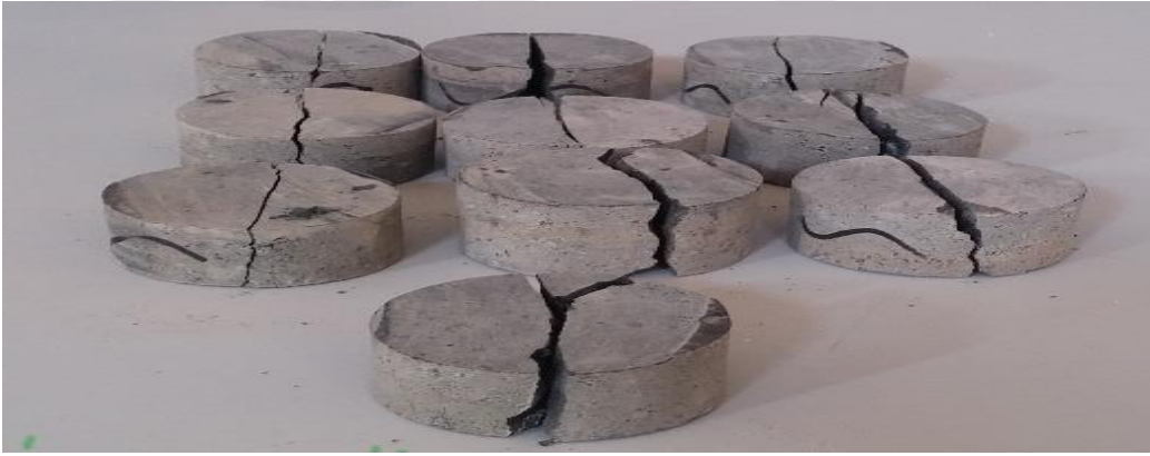
Şekil 3.21. Solhan (Bingöl ) örneklerinin Brazillian deneyinden sonraki görünüşleri
