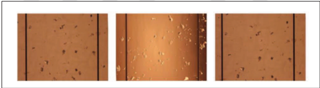
Şekil 2.4. Toz formundaki P-LDH malzemesinin optik mikroskop görüntüsü [22]
