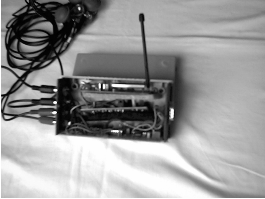
Resim 5.3. Yükselteç ve verici bölümün iç yapısı
