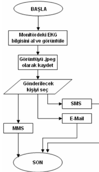
b) EKG bilgilerinin iletilmesi için hazırlanan yazılımın akış diyagramı
