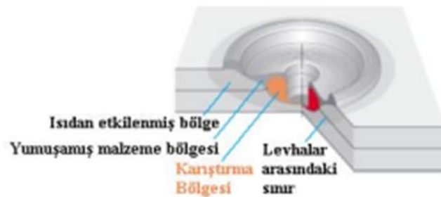
Şekil 2.5. Kaynak bölgesinin oluşumu [1].
