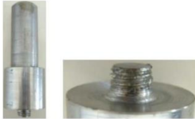
Şekil 2.7. Kaynaklarda kullanılan SKNK takımı [1], [5], [17].
