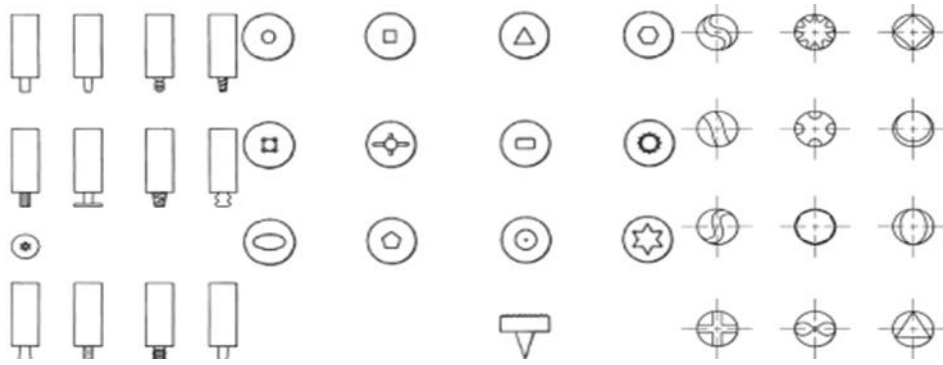
Şekil 2.4. Farklı takım omuzları ve uç profilleri örnekleri [1].
