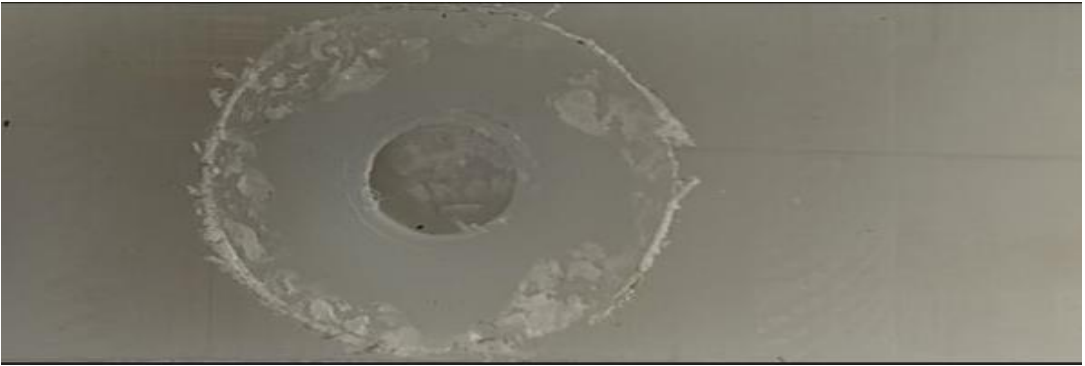
Şekil 4.50. 700 d/d takım devrinde en yüksek çekme kuvveti elde edilen G4 kaynak numunesi.
