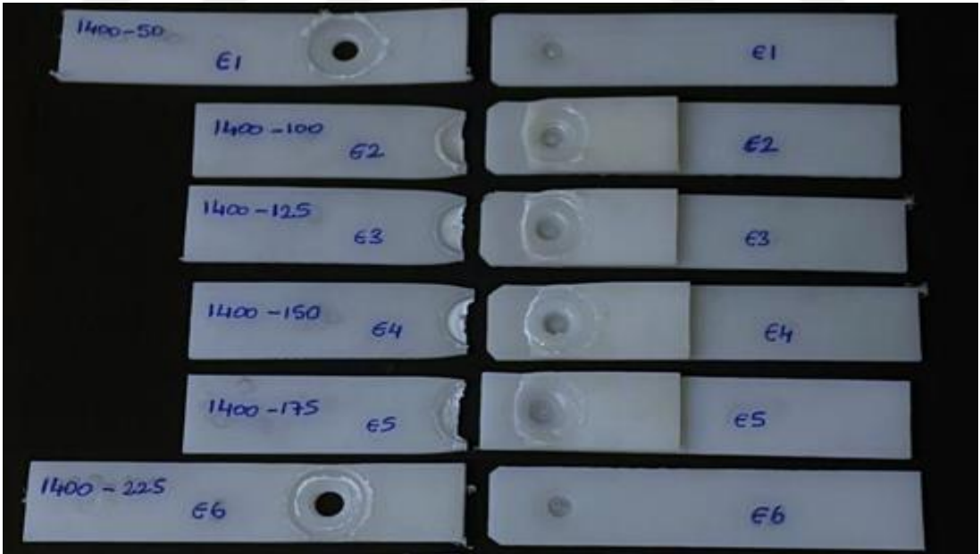
Şekil 4.35. 1400 d/d kaynak takımı devir sayısı, 6 mm takım dalma derinliği ve 100 mm/dak takım dalma hızı için, çekme deneyi sonrası sürtünme karıştırma nokta kaynağı numuneleri.
