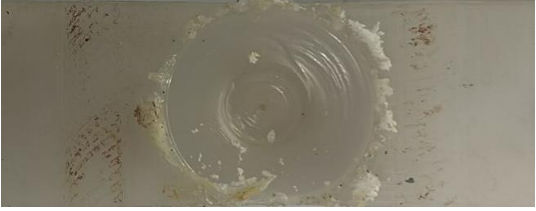
Şekil 4.51. 1400 d/d takım devrinde en yüksek çekme kuvveti elde edilen H4 kaynak numunesi.
