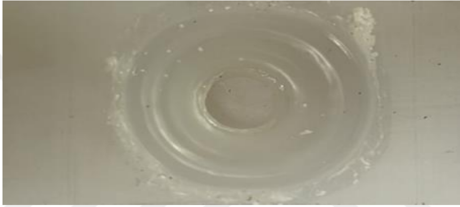
Şekil 4.13. 1400 d/d takım devrinde en yüksek çekme kuvveti elde edilen B4 kaynak numunesi.
