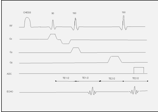
Şekil 5. PRESS sekansı diyagramı. Başlangıçta kimyasal kayma selektif saturasyon (CHES) pulsarı su sinyalini baskılar (25).
