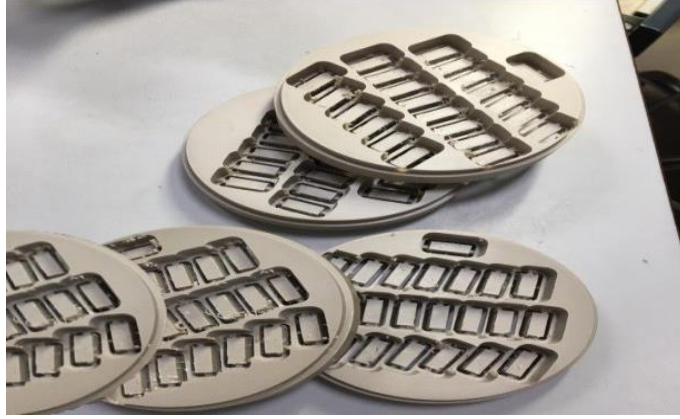
Resim 10: CAD/CAM teknolojisi kullanılarak üretimi yapılan PEEK blokların görüntüsü.
