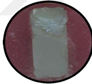
Resim 61: Koheziv ayrılma(K); üst yapı kompozitinin PEEK alt yapıdan tamamen kendi içinde kırıldığı ayrılması.
