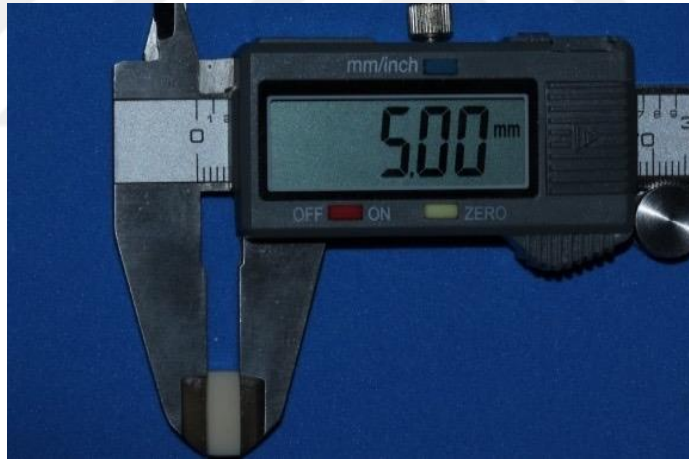
Resim 7-a: CAD/CAM teknolojisi kullanılarak üretilen alt yapı akrilik bloğun yüksekliğinin kontrol edilmesi.
