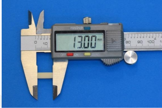
Resim 7-a: CAD/CAM teknolojisi kullanılarak üretilen alt yapı akrilik bloğun yüksekliğinin kontrol edilmesi.
