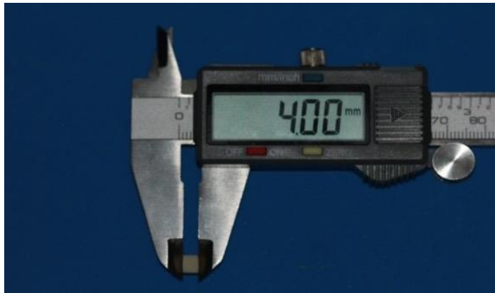
Resim 8-b: CAD/CAM teknolojisi kullanılarak üretilen veneer üst yapı akrilik bloğun uzunluğunun kontrol edilmesi.
