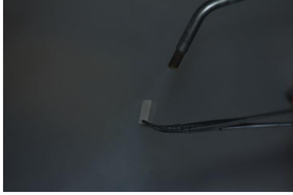
Resim 35: Kumlama işlemi yapılan PEEK örneğin sıcak buhar uygulanması.
