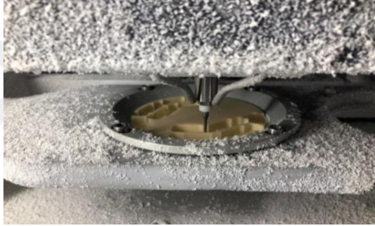
Resim 5: Alt yapı akrilik blokların ve veneer materyalinin CAD/CAM teknolojisi kullanılarak üretimi.
