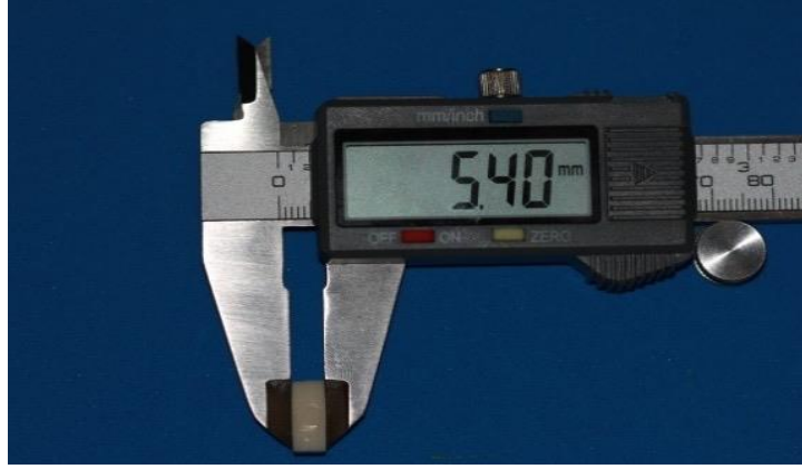
Resim 7-c: CAD/CAM teknolojisi kullanılarak üretilen alt yapı akrilik bloğun genişliğinin kontrol edilmesi.
