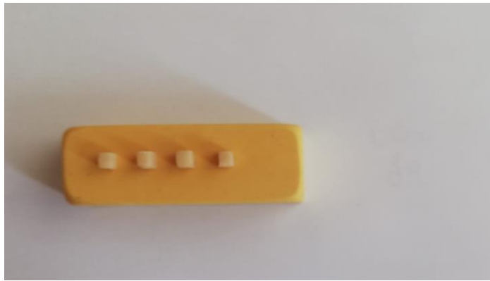
Resim 24: CAD/CAM teknolojisi ile üretilen akrilik veneer materyalinin silikona gömülmüş görüntüsü.
