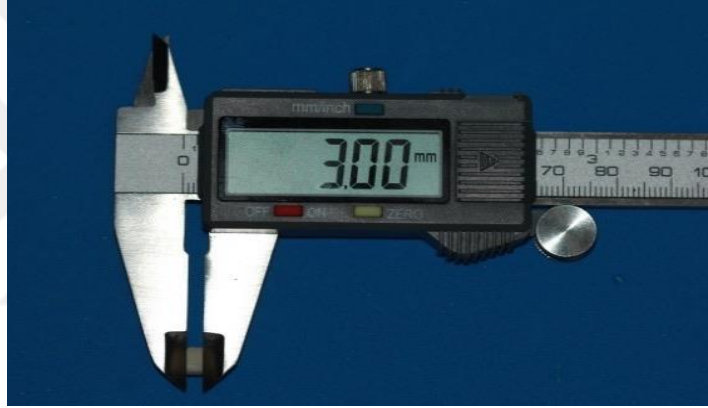
Resim 8-a: CAD/CAM teknolojisi kullanılarak üretilen veneer üst yapı materyalinin yüksekliğinin kontrol edilmesi.
