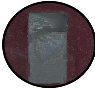
Resim 62: Kombine ayrılma (A+K); adeziv ve koheziv ayrılmanın birlikte görüldüğü ayrılma.
