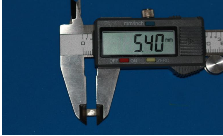
Resim 8-c: CAD/CAM teknolojisi kullanılarak üretilen veneer üst yapı akrilik bloğun genişliğinin kontrol edilmesi.
