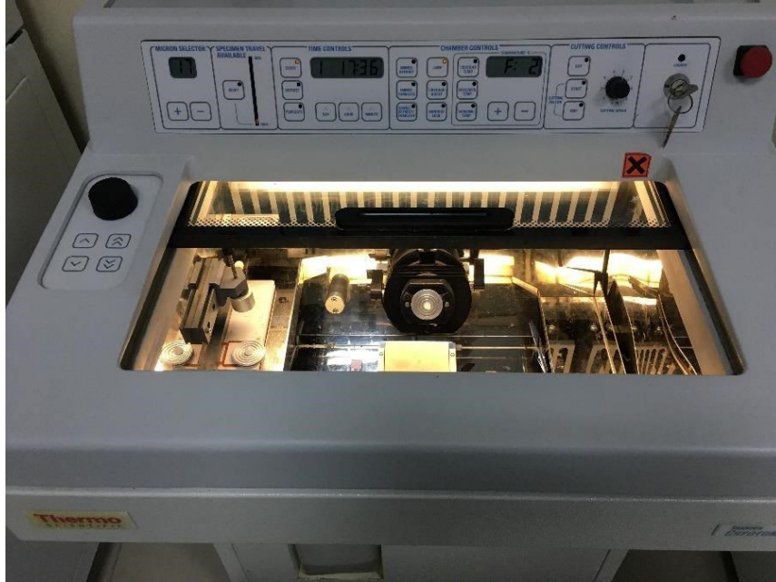
Şekil 11. Kemik doku kesitlerinin elde edildiği "Shandon marka" kryostat (Foto T. ERGÜL KALAYCI)
