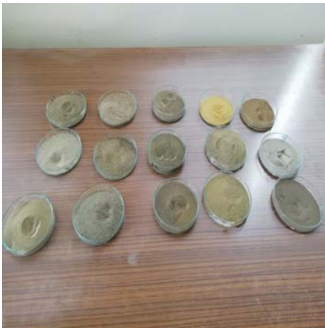
Şekil 4. Sediment örneklerinin ağır metal analizi için hazırlanışı
