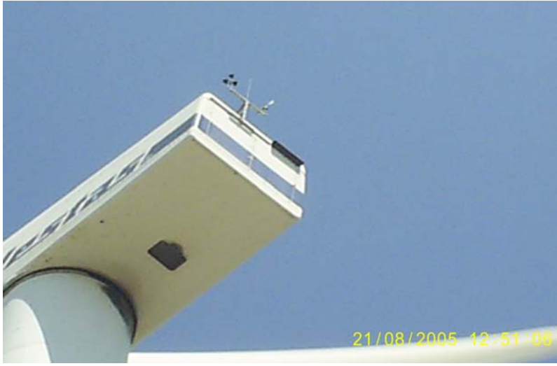
Resim 3.3. Anemometre (anemometer) ve rüzgar fırılacağı (wind vane)
