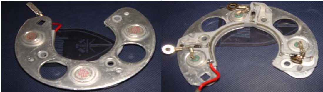
Resim 7.18. 537 ZETEX BYY58 200 kodlu diyotların önden ve arkadan görünüşü (+ diyotlar)
