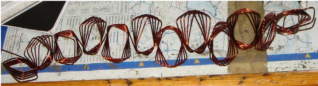
Resim 7.14. Elde sarılmış olan bir faza ait 12 bobin sayısı (endüvi sargısı)
