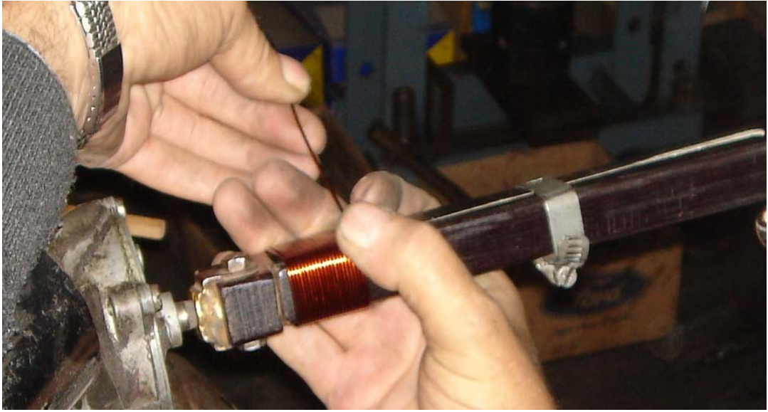
Resim 7.13. Endüvi sargısının elde sarılması (kalıp 5 cm x 2 cm boyutlarında)
