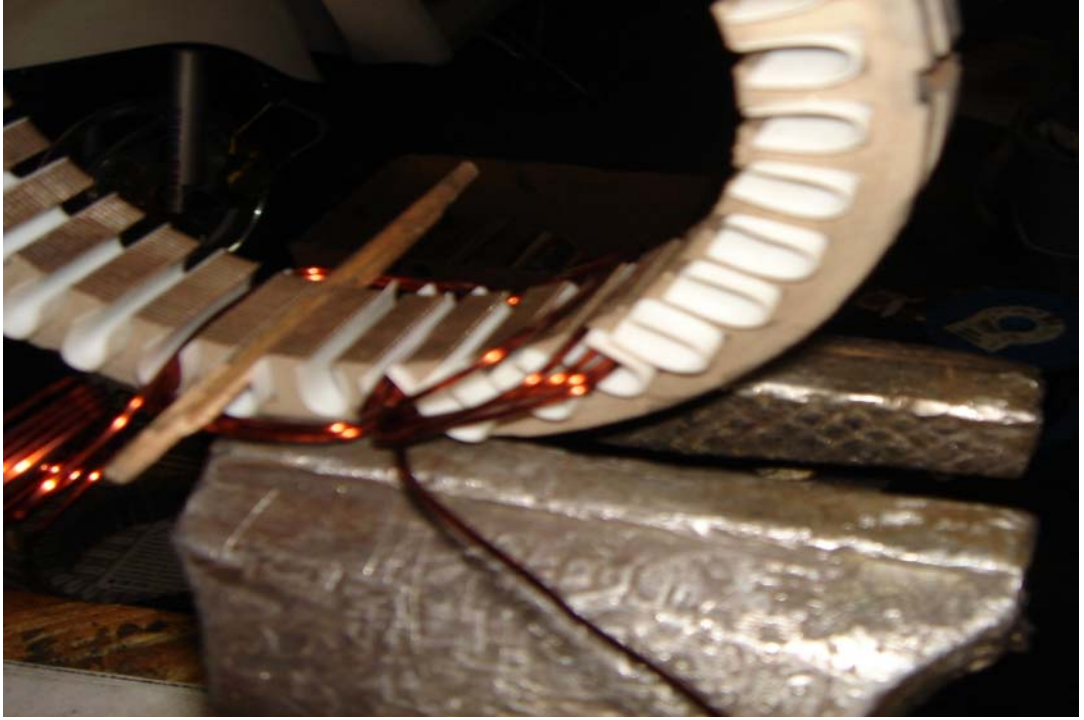
Resim 7.15. Endüvi sargısı 36 oluklu stator çekirdeğine yerleştirilmiştir ve sargıların oynamaması için gürgen tahta kullanılmıştır
