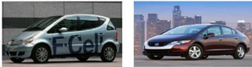
Şekil 3.6. Yakıt hücresiyle çalıştırılan ticari arabalar (a)Mercedes F-Cell (2005) (b)Honda FCX Clarity (2007).
