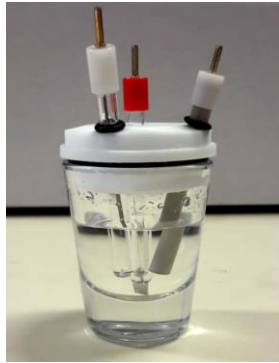
Şekil 3.16. Katalizörlerin elektrokimyasal karakterizasyonunda kullanılan üç elektrotlu hücre sistemi
