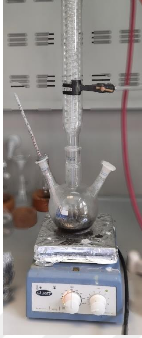
Şekil 3.1. Konvansiyonel ısıtmalı poliol yönteminde kullanılan geri akışlı sentez sistemi
