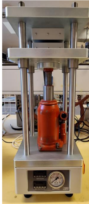
Şekil 3.18. MEA hazırlamada kullanılan sıcak pres sistemi
