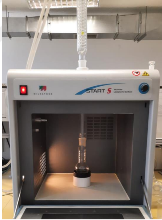
Şekil 3.2. Mikrodalga destekli poliol sentezinde kullanılan sentez sistemi
