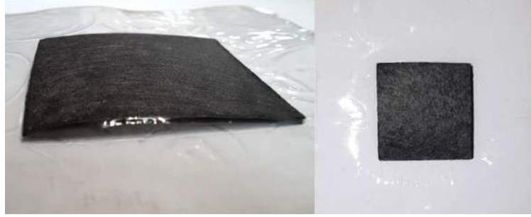
Şekil 3.19. Sıcak presleme sonrasında elde edilen membran elektrot yığını
