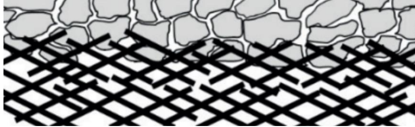
Şekil 2.12. Sigracet karbon kâğıt gaz difüzyon tabakasını oluşturan iki yapının gösterimi
