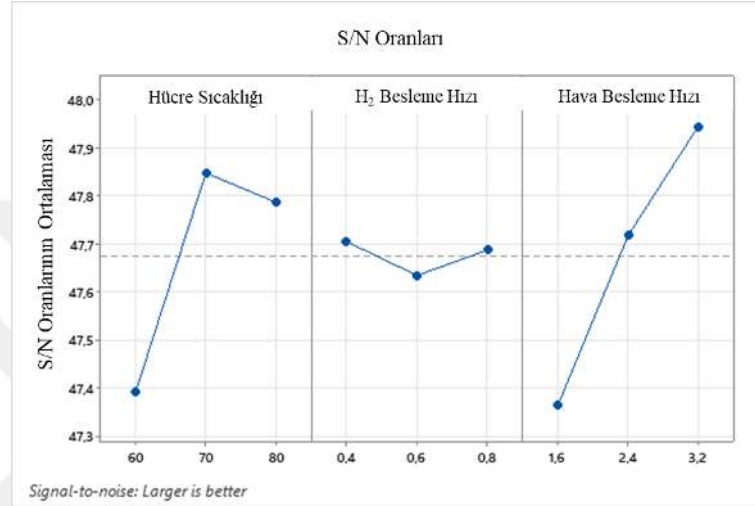
Şekil 5.3. Ticari %20 Pt/C katalizöründe sinyal-gürültü (S/N) oranının hücre sıcaklığı, hidrojen besleme hızı ve hava besleme hızı parametrelerinde değişimi
