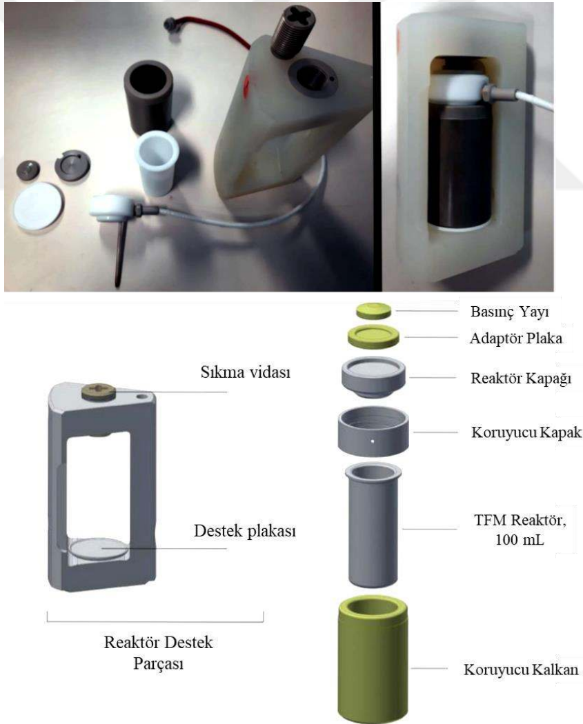
Şekil 3.5. Mikrodalga destekli polioli yöntemi ile yüksek basınçta katalizör sentezi çalışmalarında kullanılan reaktör sisteminin genel görünümü ve bu sistemi oluşturan parçalar
