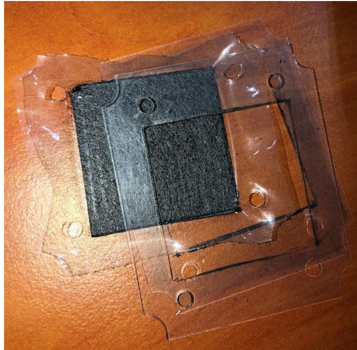
Şekil 4.12. Deney esnasında kullanılan delinmiş bir elektrolit membran
