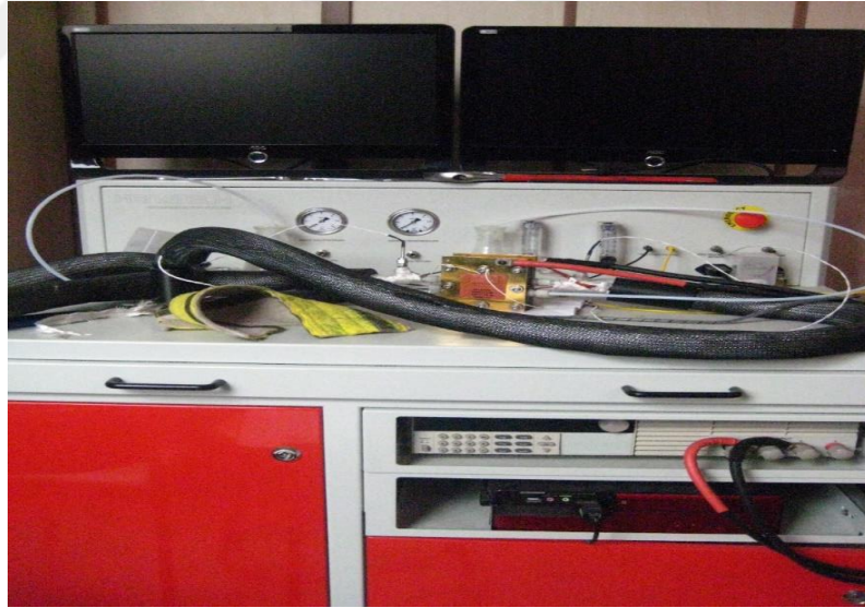
Şekil 3.1. Performans ölçümlerinde kullanılan yakıt pili test istasyonu
