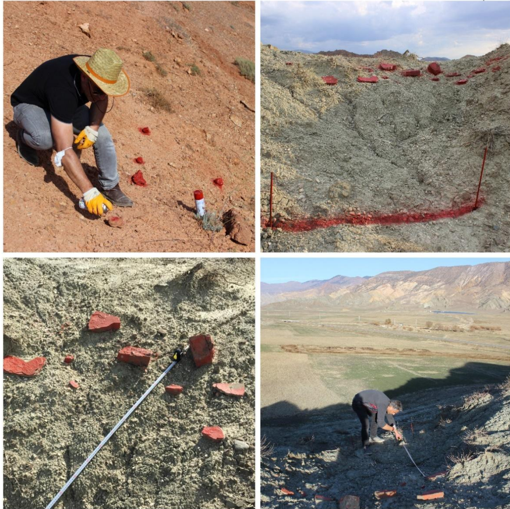
Fotoğraf 2 Yamaçlarda Eğim, Yağışın Şiddeti ve Süresine Bağlı Olarak Taşınan Çakıl ve Blok Boyutundaki Sedimanın Taşınma Mesafesinin Ölçümü ve Daha Küçük Boyutlu Sedimanlara Gömülme Durumunu Belirlemek için Uygulanan Boyalı Taş Yöntemi
