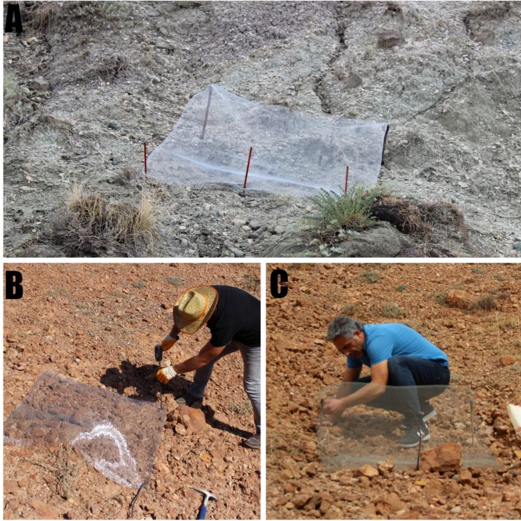
Fotoğraf 3 Yamaç Erozyonunun Şiddetinin Belirlenmesi Amacıyla Kurulan Ağ (A), Ağ Kurulumun (B) ve Biriken Sediman Örneklerinin Alınma Aşamasından (C) Birer Görünüm.
