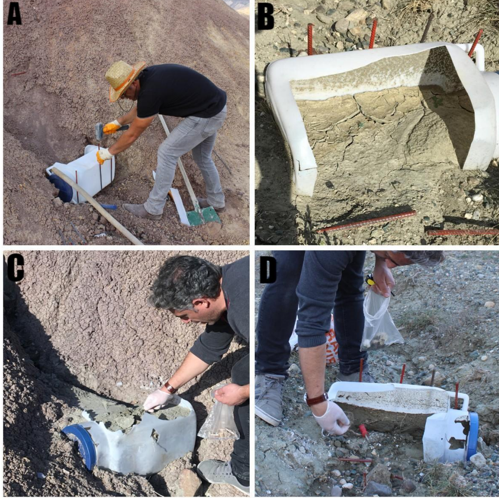
Fotoğraf 1 Yamaç Eteklerine Taşınan Sedimanın Miktarı, Şekil ve Boyutlarının Tespiti Amacıyla Kurulan Sediman Tuzaklama Yöntemi. (A) Sediman Tuzaklama Kurulumu, (B) Kurulan Tuzakta Biriken Sediman, Güney (C) ve Kuzey (D) Yamaçlardaki Tuzaklarda Biriken Sedimanlardan Toplanan Örnekler
