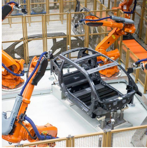
Resim 2. 3 Otomatik Makine ile Perçinleme Yapılışı (İnt.Kyn.3).
