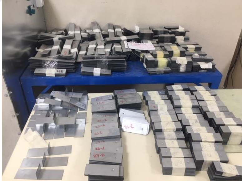
Resim 3. 4 Kesme deneyi için birleştirilmiş malzemeler
