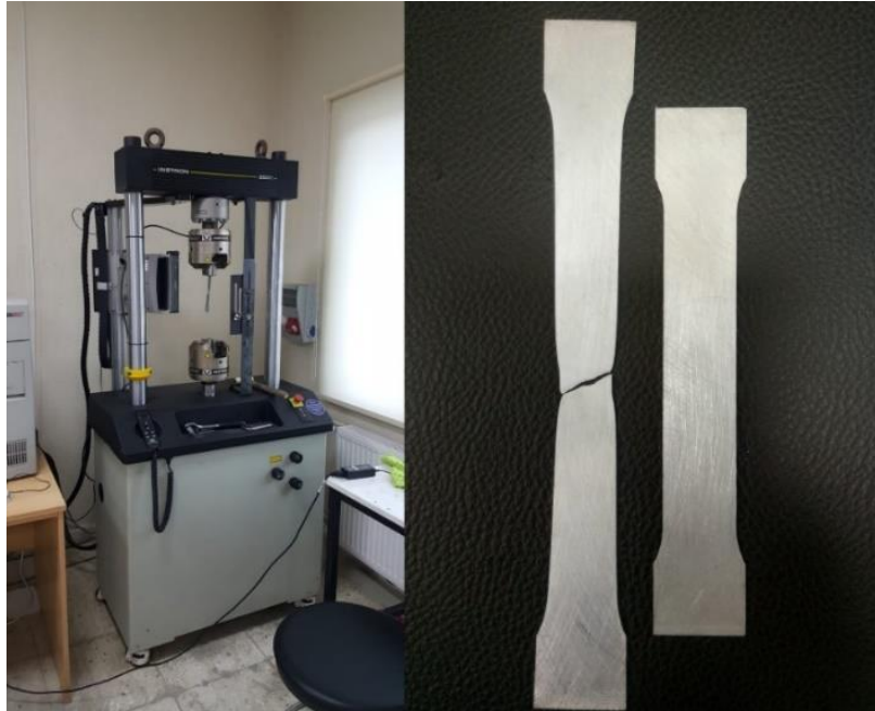
Resim 3. 7 Test için hazırlanmış numune ve test
