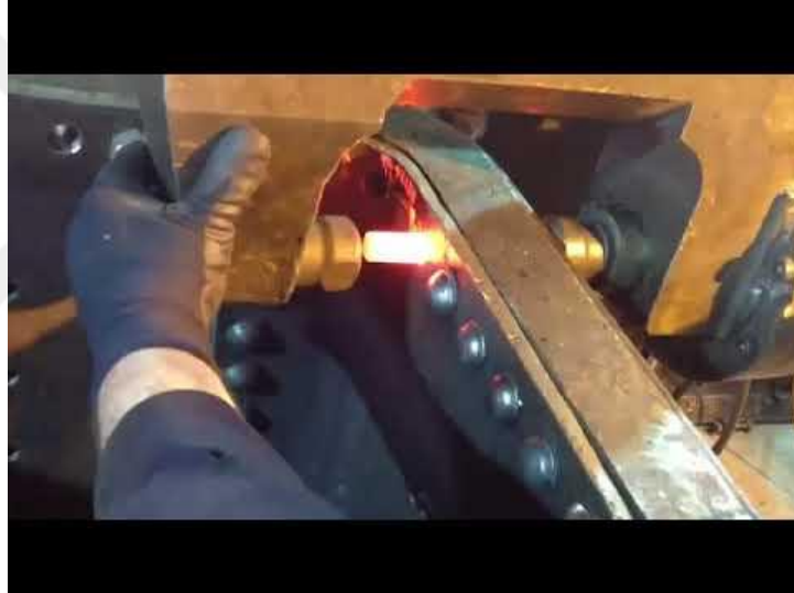
Resim 2. 1 Sıcak Perçinleme Yapılışı (İnt.Kyn.1).
