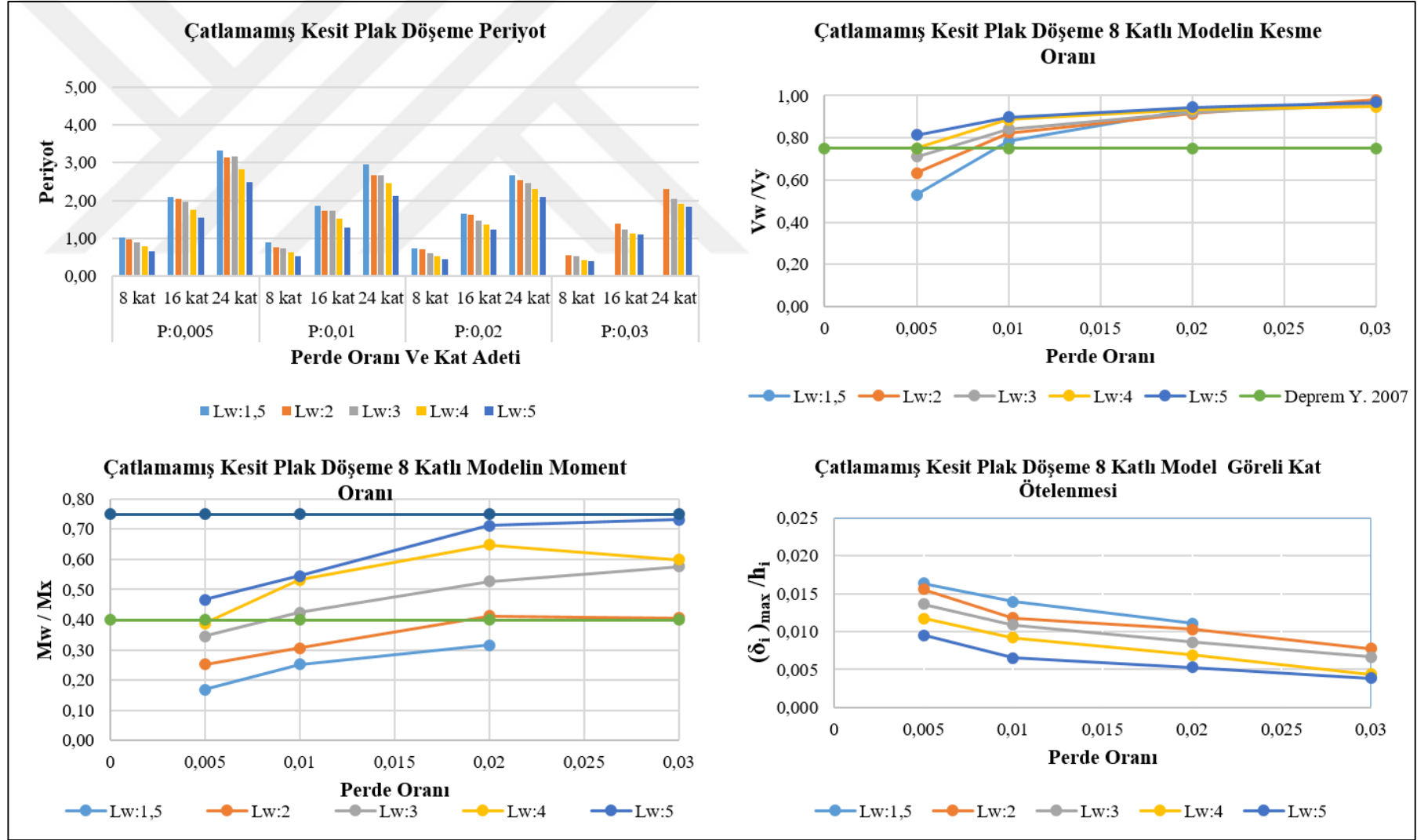
Şekil 4.4. 8 katlı çatlamamış kesitli plak döşemeli modeller için perde oranının yapı kuvvet dağılım etkisi
