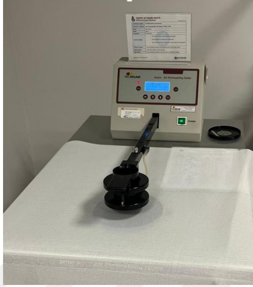
Şekil 2.14 : Kumaş hava geçirgenliđi ölçme cihazı.
