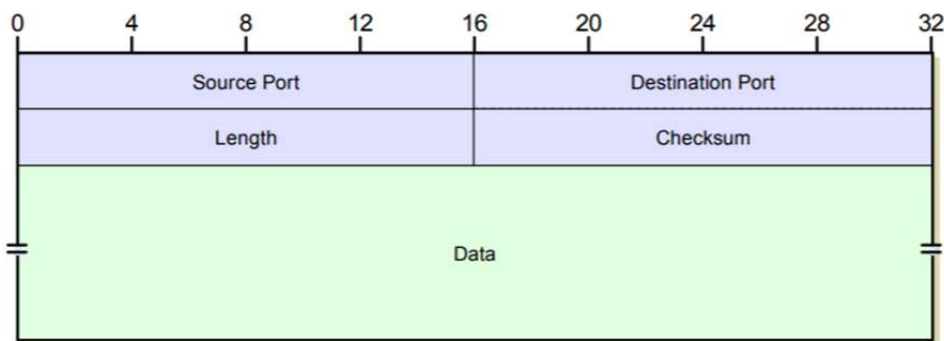
Figure 3.8. UDP Message Format (Kozierok C. M., n.d.)
